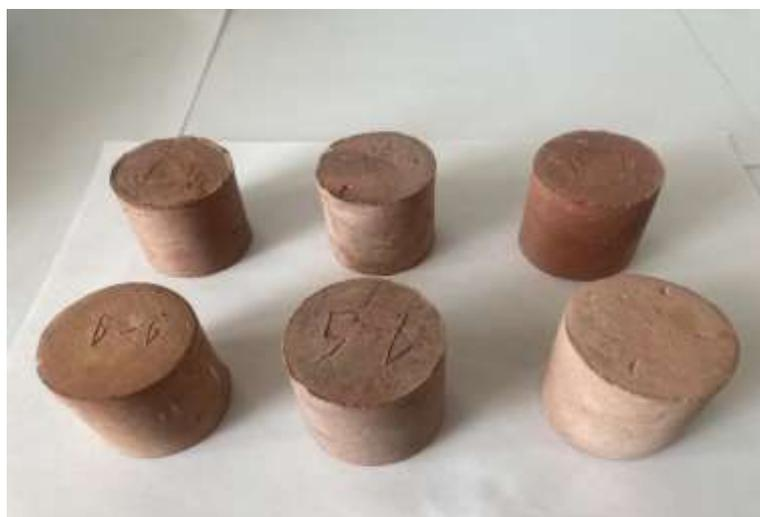
Рисунок 25 - Лабораторные образцы на основе аргиллита и алевролита
