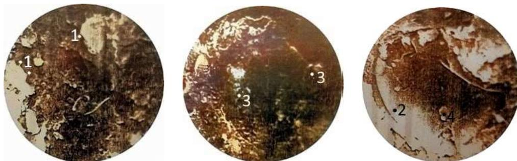
Рисунок 15– Электронно-микроскопические фотографии высокоминерализованных углистых пород. Рабочие увеличения 600-1800<sup>x</sup>: 1 – угловатые обломки; 2 – объекты округлой формы; 3 – пирит; 4 – марказит.
