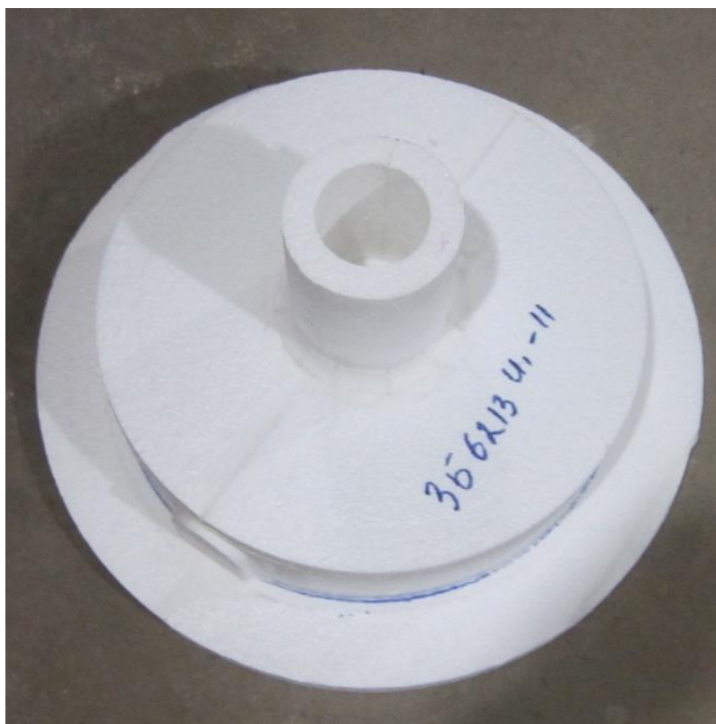
Рисунок 6.1 – Модель отливки «Колесо ходовое»
