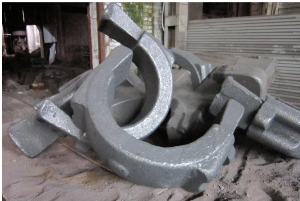
Рисунок 4.5 – Отливка «Скоба», полученная в опоках с гофрированным металлорукавом
