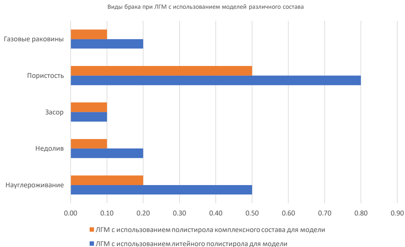
Рисунок 6.7 – Виды брака при ЛГМ с использованием моделей различного состава
