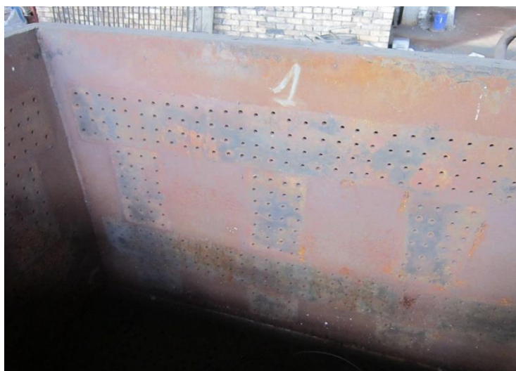
Рисунок 4.3 – Вакуумированная опока с боковым и нижним забором воздуха
