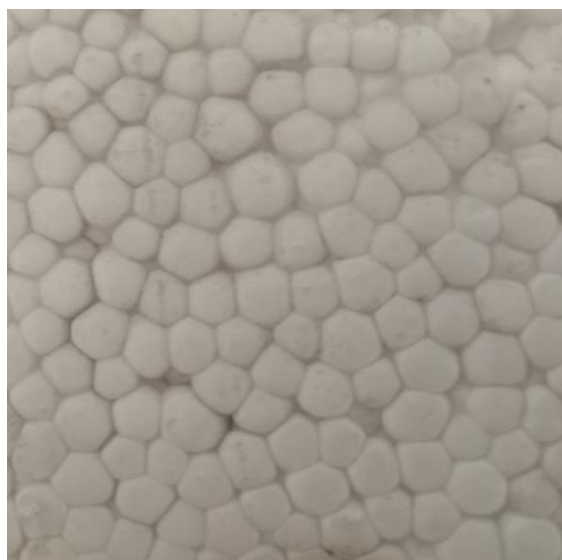
Рисунок 3.4 – Структура модели комплексного состава: 40% строительного полистирола марки ППС-20; 60% литейного полистирола марки ПСВ-1Л
