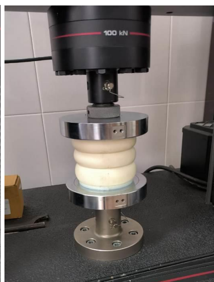
Рисунок 10 – Испытания отбойников лифтов и виброизоляторов
