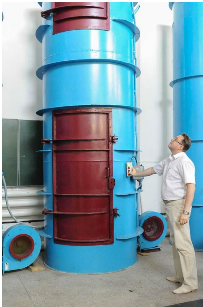
1-сурет – Ғимараттар мен құрылыстарға арналған жүк пневматикалық көтергіштің тәжірибелік-өнеркәсіптік үлгісі
