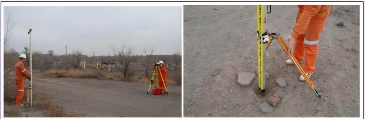
**Рисунок 2** – Замер оседания земной поверхности по реперу
