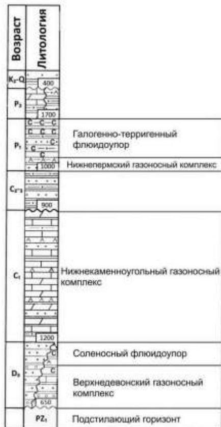
Рисунок 1.6 -Литолого-стратиграфический разрез Кокпансорского газоносного района
