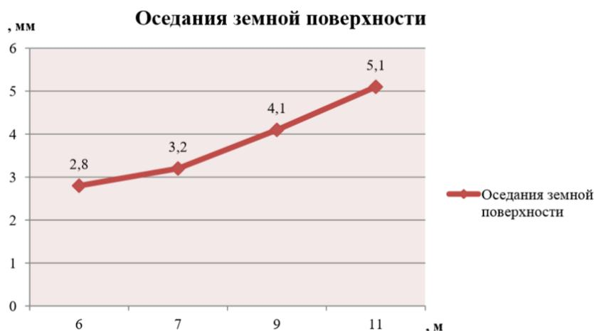
Рисунок 5.3 – Значение максимальных оседаний земной поверхности при различных мощностях рудного тела р. «Жомарт»
