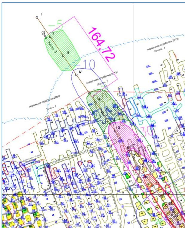
Рисунок 5.2 – Оседания земной поверхности по профильной линии №2
