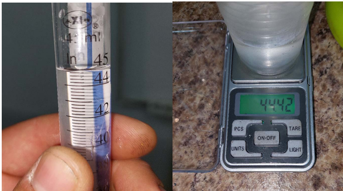
Рисунок 2.29 - Определение объёма жидкости при помощи мерной колбы и массы жидкости на весах
