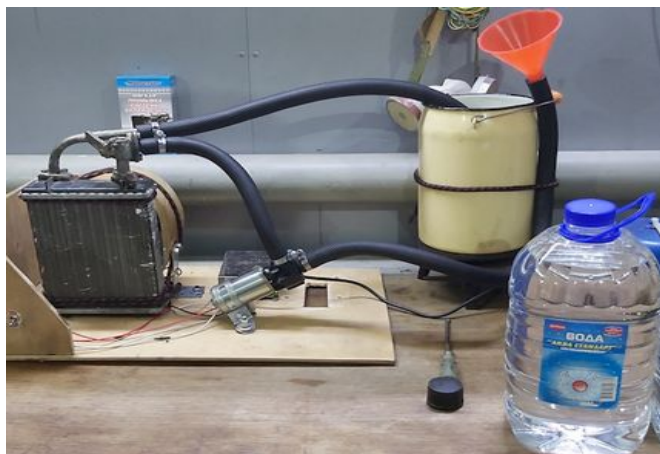
Рисунок 13- Метод промывки пластиковыми бутылками
