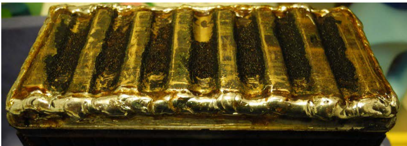
Рисунок 2.17- Пайка бачка радиатора
