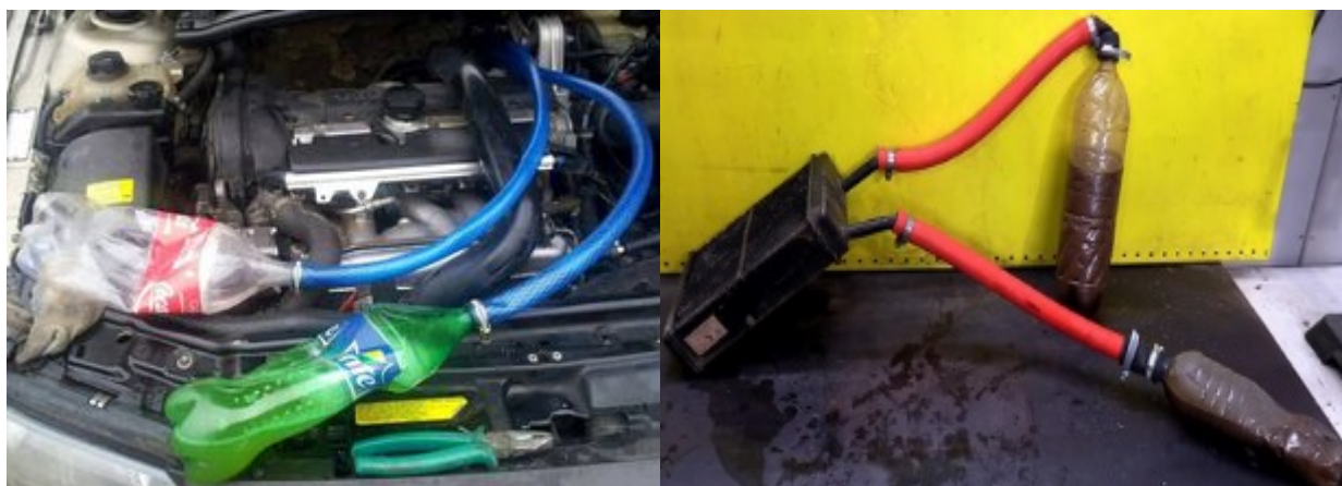
Рисунок 2.12- Метод промывки пластиковыми бутылками
