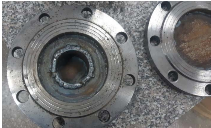
Рисунок 3.9- Фланец для крепления ультразвукового излучателя
