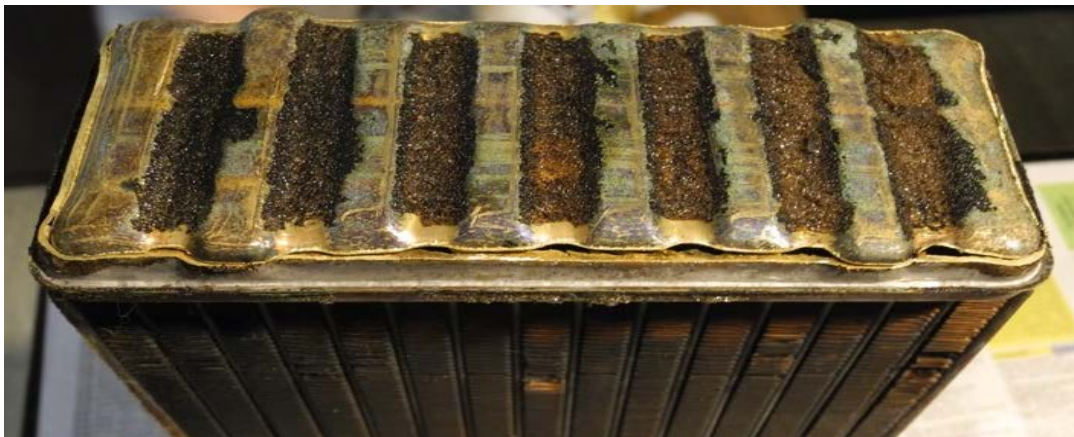
Рисунок 2.14- Разрез заднего бачка радиатора отопителя салона
