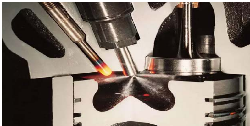
Рисунок 3.3- Неразделенная камера сгорания дизельного двигателя
