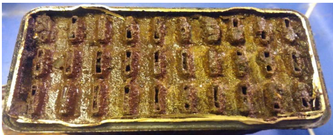
Рисунок 2.15- Открытый задний бачек радиатора отопителя салона
