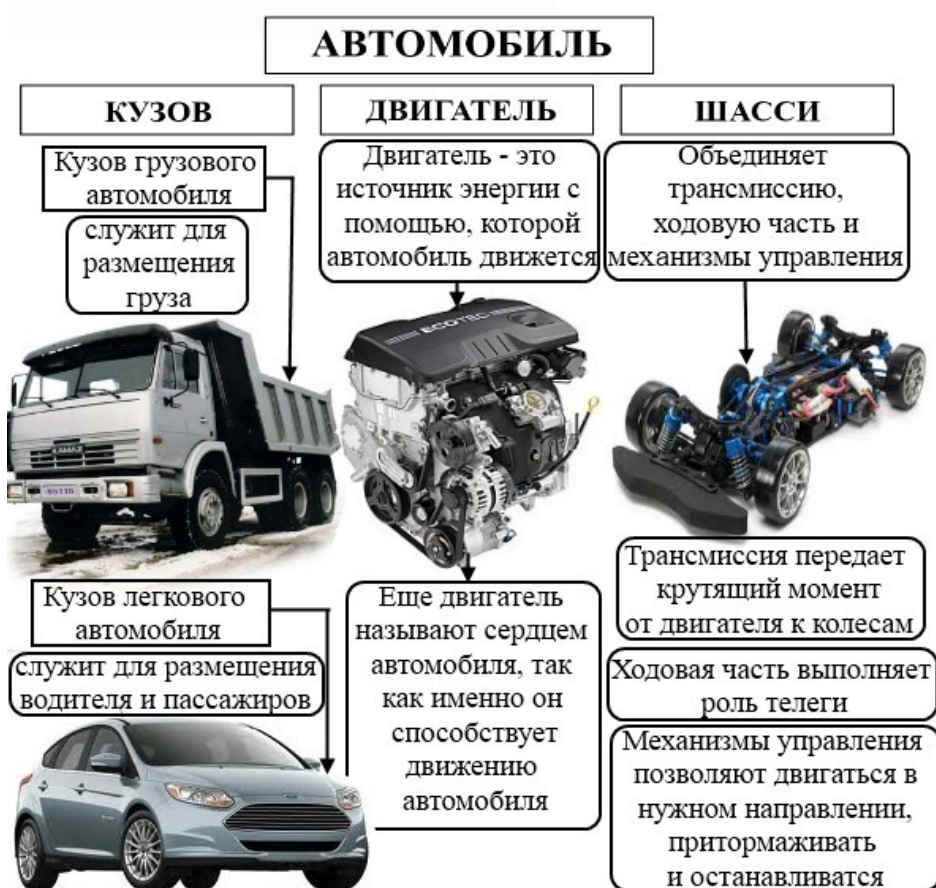
Рисунок 1.1- Основные части автомобиля
