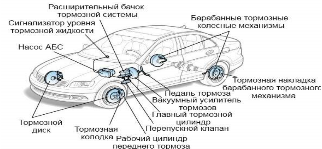
Рисунок 1.8- Тормозная система автомобиля
