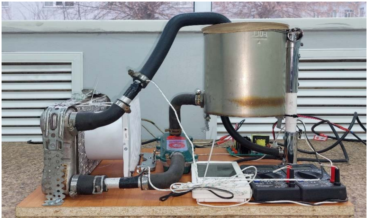
Рисунок 2.22 – Экспериментальный стенд для ультразвуковой очистки автомобильных радиаторов.
