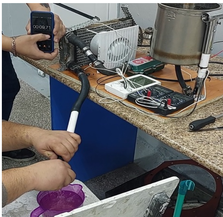
Рисунок 2.30 - Определение времени истечения жидкости через радиатор
