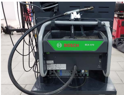
Рисунок 3.20- Дымомер оптический «BEA 070»
