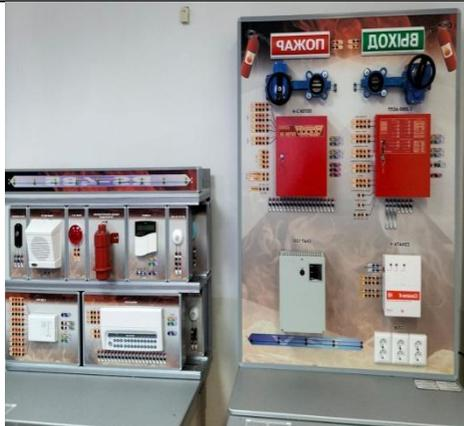
Интерактивный демонстрационно-тренажерный стенд "Системы автоматического пожаротушения" предназначен для изучения принципов монтажа и соединения компонентов, автоматических охранно-пожарных систем на базе различных (по желанию заказчика) приемно-контрольных приборов, а также их работы в составе автоматической противопожарной защиты
