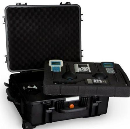
Комплект КОМБИ-СОУТ предназначен для измерения шума, вибраций, электромагнитных полей промышленной частоты 50 Гц, освещенности рабочих мест, ультра фиолетового излучения в производственных помещениях промышленных предприятий.
