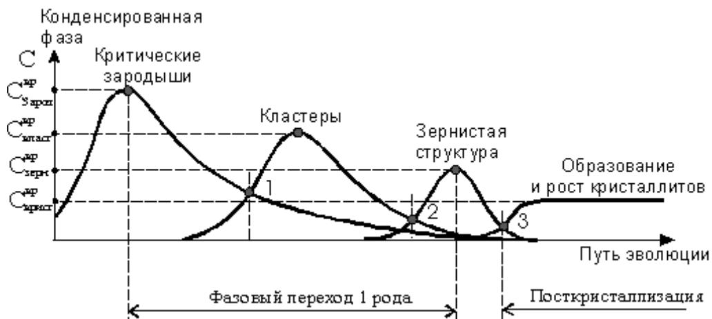
Рисунок 2.8 – Последовательность фазовых переходов второго рода в процессе кристаллизации
