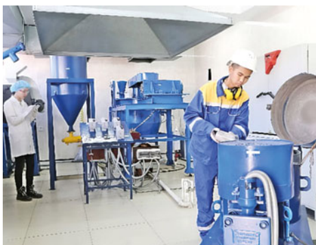
Обучающийся Амангельдинов А. А. запускает планетарную мельницу мелкого помола для проведения НИР, 2020 г.
