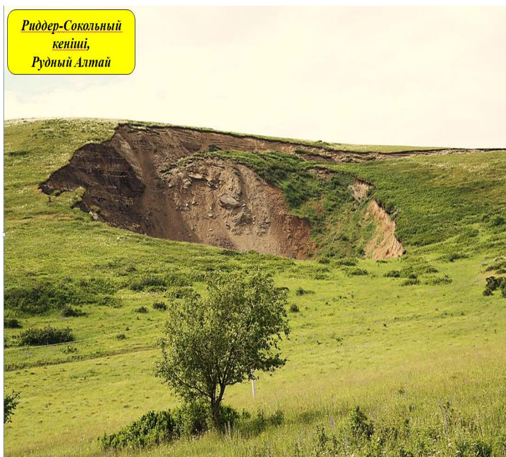
Сурет 1.8 - Риддер-Сокольное кен орнында қорғаушы кентіректің өздігінен құлауы
