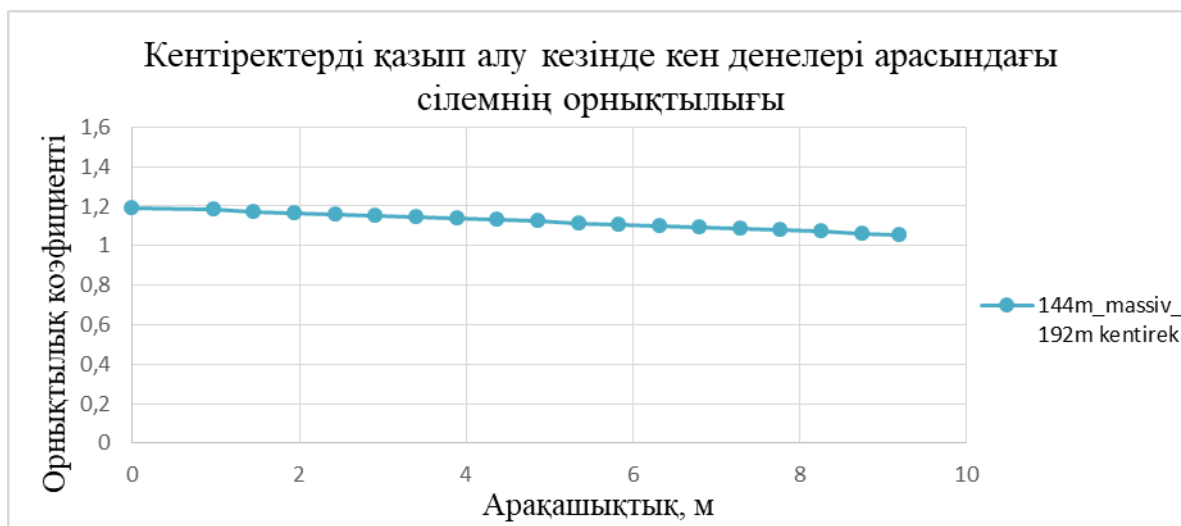
Сурет 4.9.4 – 4 және 6-кен денесі бойынша +192 м және +144 м деңгейжиектерінің арасындағы төбе кентіректерін қазып алу кезіндегі кен денелерінің арасындағы сілемнің орнықтылығы
