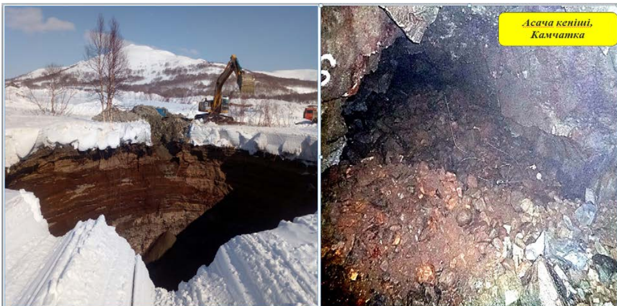
Сурет 1.10 - Асача кен орнында қорғаушы кентіректің өздігінен құлауы
