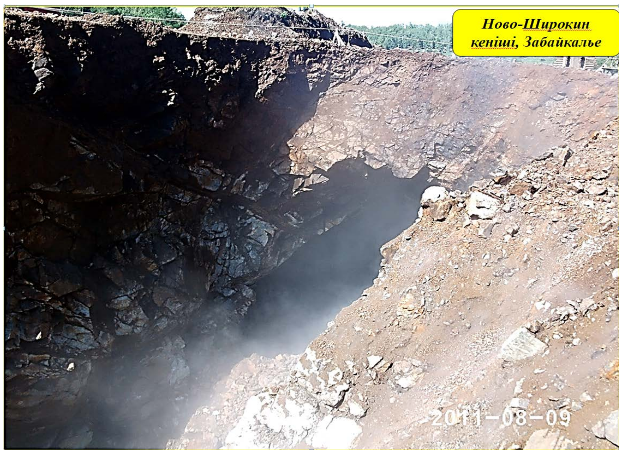
Сурет 1.5 - Ново-Широкин кен орнында қорғаушы кентіректің өздігінен құлауы
