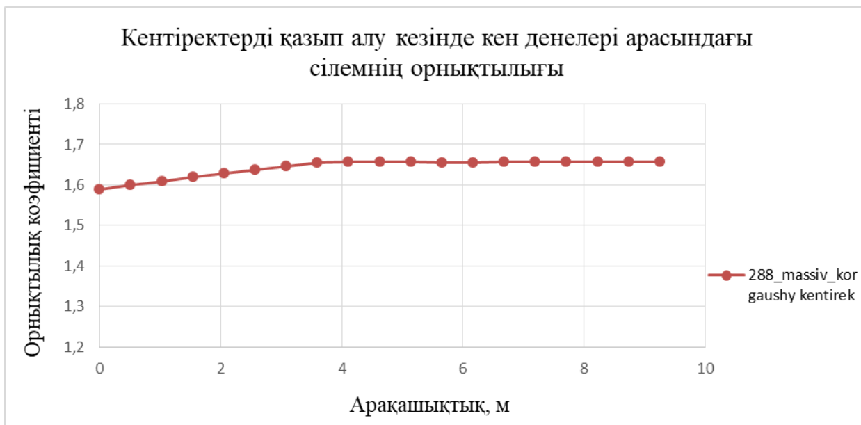
Сурет 4.6.3 - 4 және 6-кен денесі бойынша аршық пен жерасты кенішінің арасындағы қорғаушы кентіректерді қазып алу кезіндегі кен денелерінің арасындағы сілемнің орнықтылығы
