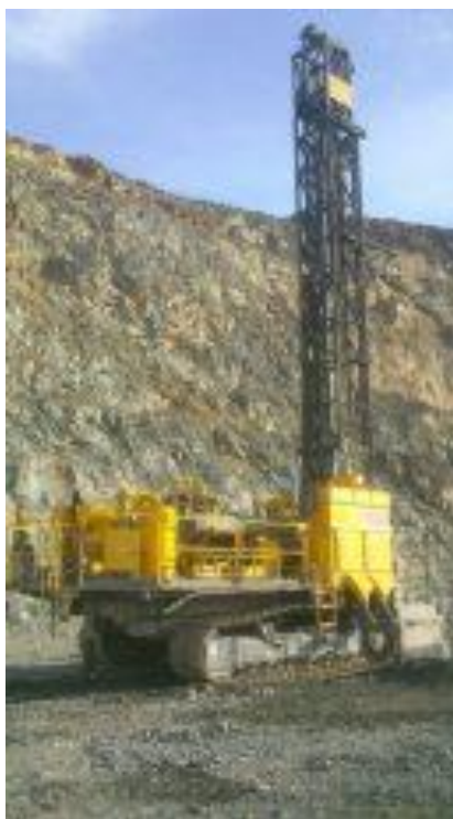
Сурет 1.6 –DML LPE 1600/110 бұрғылау құрылғысы
