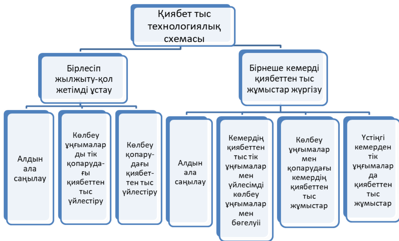
Сурет 4.1 - Жобалық контурдағы кемерлерді қиябетін шекті орнықтылық жағдайына келтірудің технологиялық схемаларын жіктеу
