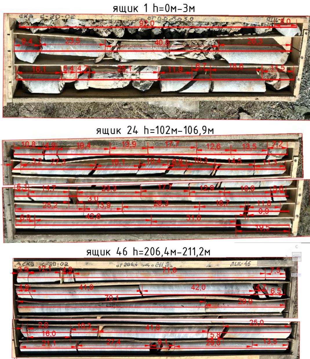
Сурет 2.3 - С-20-02 Бұрғыланған С-20-02 ұңғыманың тереңдігі бойынша құрылымдық блоктардың мөлшерін анықтау фрагменттері
