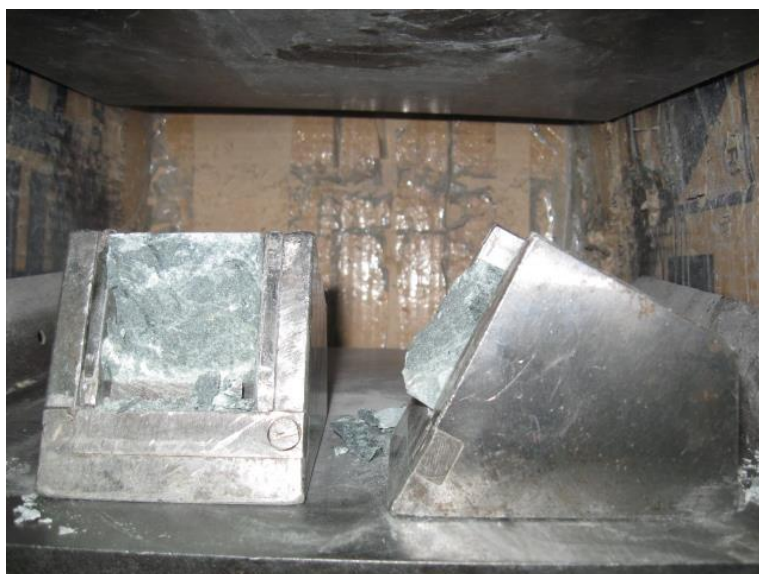
Сурет 2.17– Сығылып кесу кезінде тау жыныстарын беріктік шегіне сынау нәтижелері
