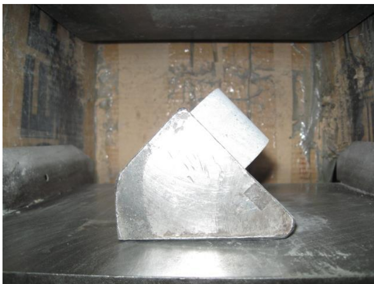
Сурет 2.16 – Матрицаларды пресс көмегімен қысу арқылы кесу кезінде тау жыныстарын беріктік шегіне сынауға дайындау
