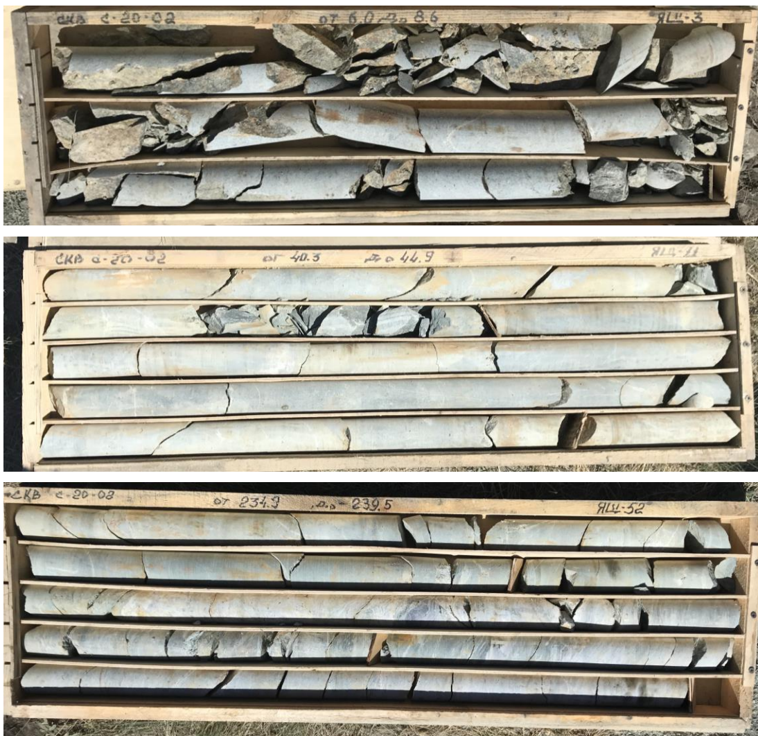
Сурет 2.13 – С-20-02 инженерлік-геологиялық ұңғымасы бойынша керндерді тасымалдауға және зертханаға жөнелтуге дайындалған
