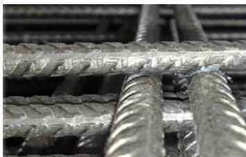
1.11 сурет - Айқастырып біріктірілген тор сымдарының металл қаңқасы
