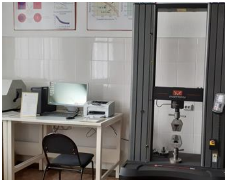
2.9 сурет - INSTRON 5980 электромеханикалық сынақ машинасы
