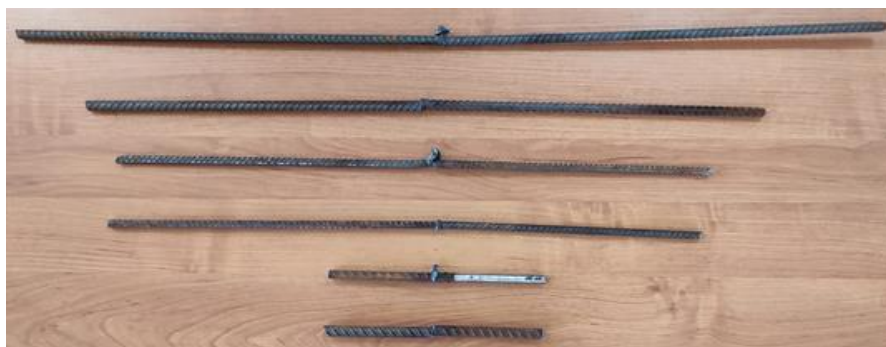
2.13 сурет - Үйкеліспен дәнекерлеп біріктірілген кейбір арматуралық өзекшелер
