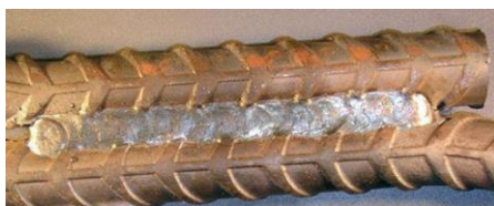
1.9 сурет - Арматураны қабаттастырып дәнекерлеумен біріктіру
