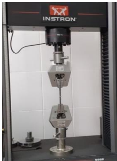
2.17 сурет – Үлгілерді сынау процесі
