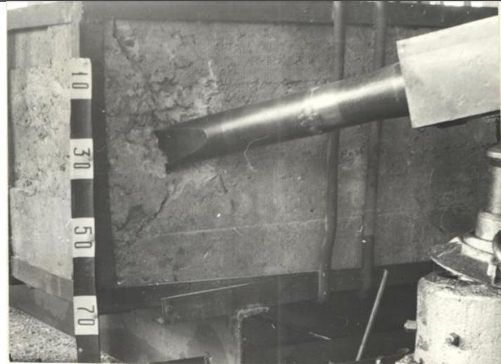
ПГУ-3 на крепи КМ87; разрушенный блок
