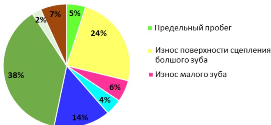
Рисунок 1.5 - Общая причина выхода из строя автосцепок локомотивов
