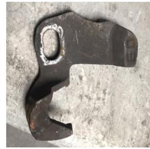
Рисунок 2.10 - Замкодержатель автосцепного устройства
