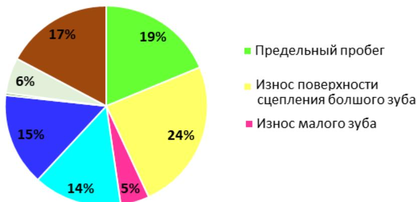
Рисунок 1.3 - Причины выхода из строя фронтальных автосцепок локомотивов KZ8A
