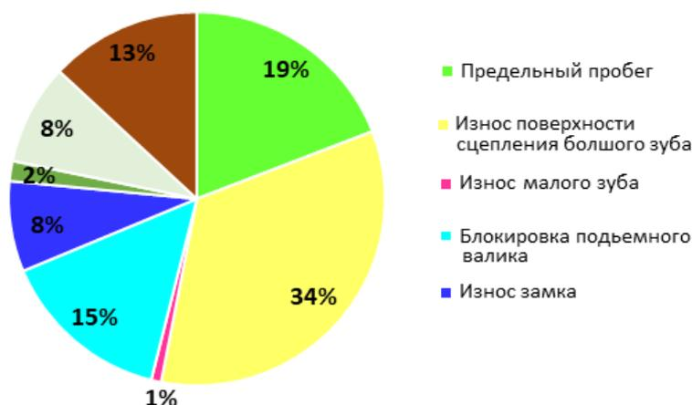
Рисунок 1.2 - Причины выхода из строя автосцепок локомотивов KZ4AT
