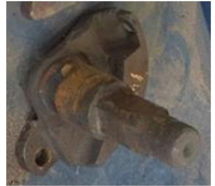
Рисунок 2.12 - Валик подъемника
