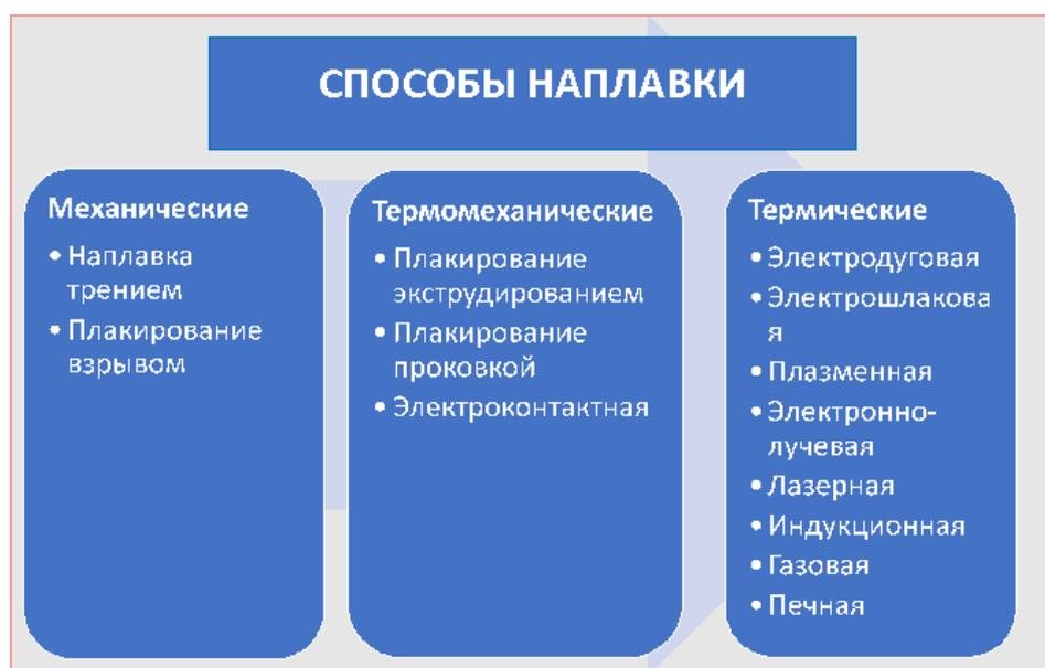
Рисунок 1.11 - Способы наплавки
