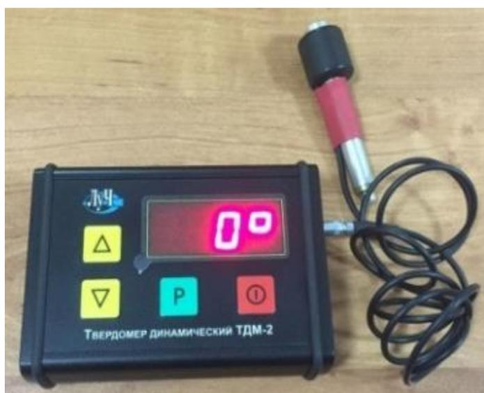
Рисунок 3.3 – Прибор ТДМ-2 для измерения твердости обработанной поверхности
