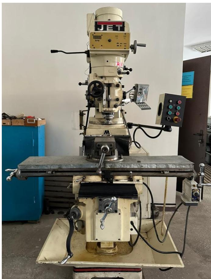
Рисунок 3.1 - Вертикально-фрезерный станок модели JTM-1050 VSE JET
