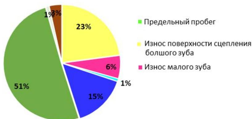
Рисунок 1.4 - Причины выхода из строя межсекционных автосцепок локомотивов KZ8A
