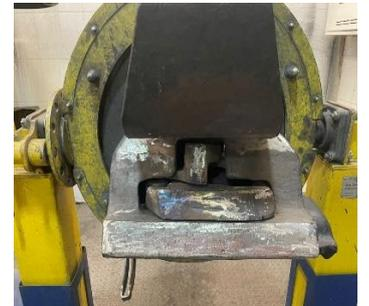
Рисунок 2.16 - Некоторые детали автосцепного устройства подготовленные для наплавки
