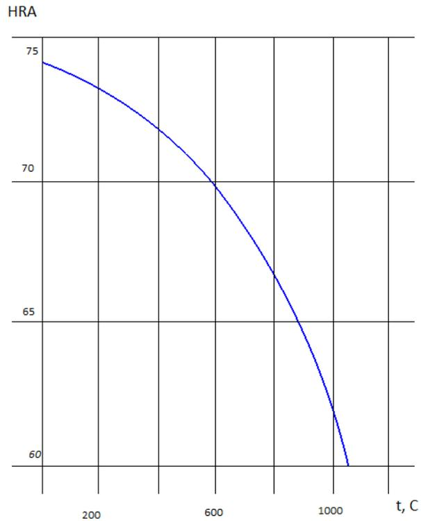
Рисунок 4.10 – Изменение твердости по шкале Роквелла в зависимости от температуры низколегированной мартенситной стали
