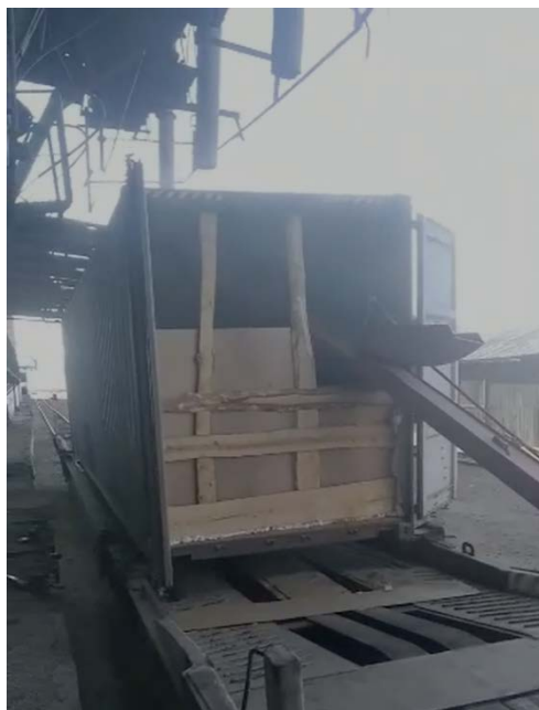
Сурет 1.8 – Сарыбел станциясына жапсарлас элеваторда астықты арнайы пневмоқұрылғы көмегімен контейнерге тиеу
