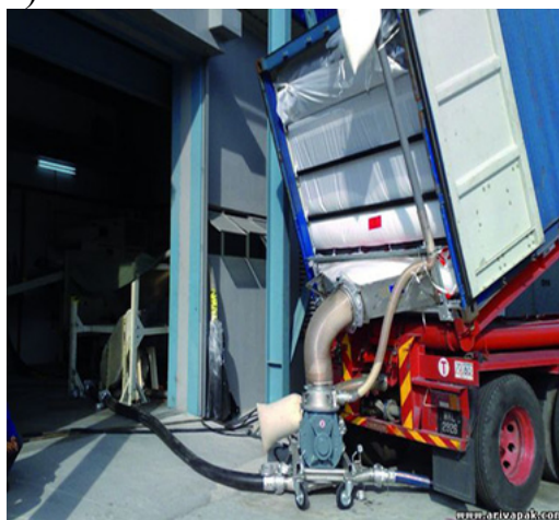
Сурет 1.9 – Пневмотранспортердің көмегімен лайнер-бэгті жүктеу (а) және түсіру (б)
