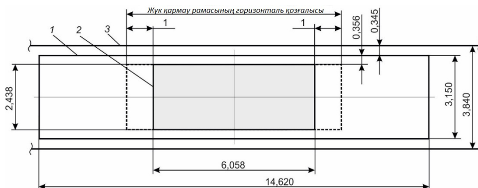
Сурет 4.2 – Темір жол платформаларындағы контейнерлерге үйілме жүктерді тиеуге арналған көтергіштің 2-ші жұмыс режимінің есептік сызбасы
