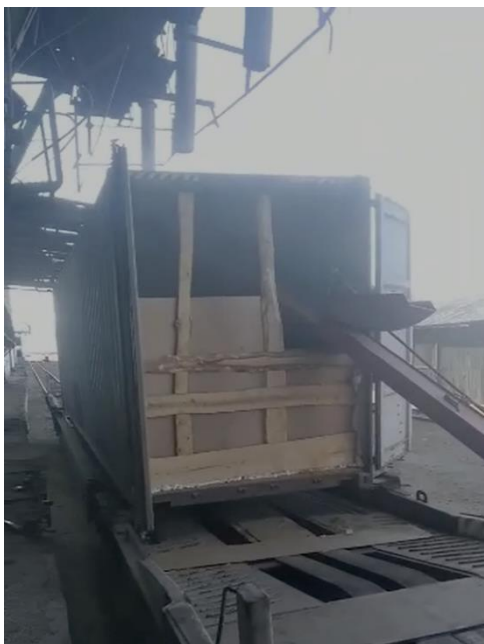
Сурет 1.8 – Сарыбел станциясына жапсарлас элеваторда астықты арнайы пневмоқұрылғы көмегімен контейнерге тиеу
