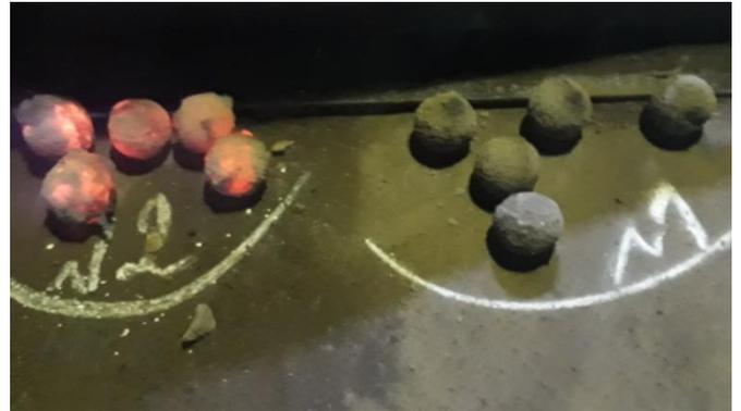
Рисунок 11 – Отбор шаров из модифицированного НХЧ для проведения механических и металлографических испытаний
