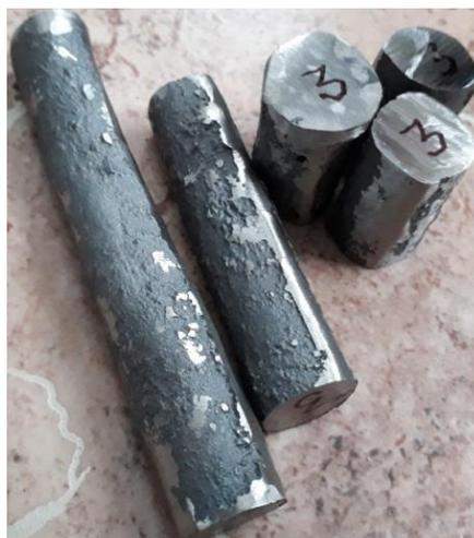
Рисунок 7 – Литые из модифицированного чугуна стержни для изготовления образцов
