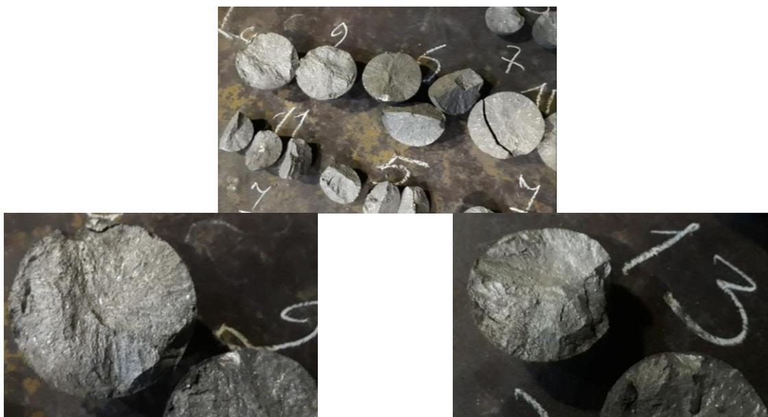
Рисунок 54 – Разрушенные на ударном копре чугунные шары из модифицированного НХЧ
