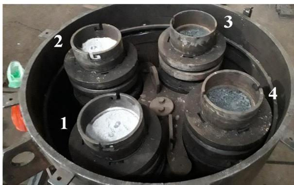
Рисунок 60 – Четырёхкамерная планетарная шаровая мельница перед испытаниями
