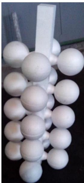
Рисунок 58 – Модельный блок при литье шаров по технологии ЛГМ
