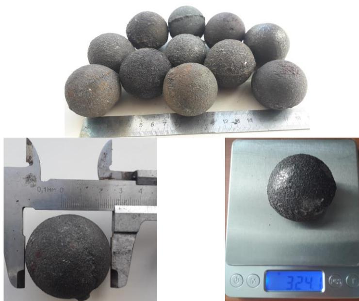
Рисунок 61 – Внешний вид, размеры и масса мелющих шаров до испытаний
