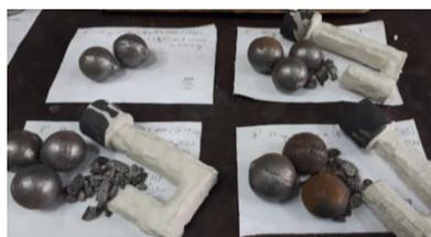
Рисунок 2 – Металлическая шихта и пенополистероловые модели, подготовленные для отливки образцов
