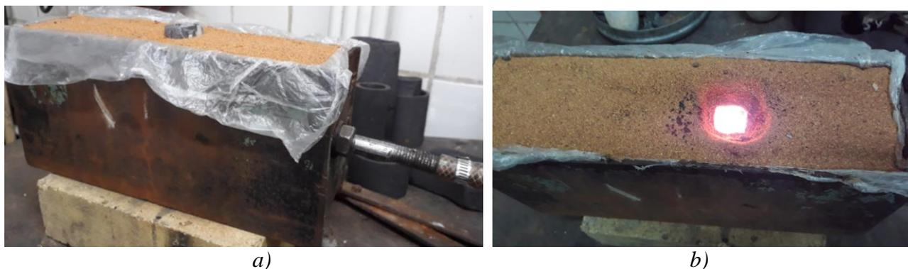
Рисунок 3 – Вакуумируемая ЛГМ-форма: а – перед заливкой; б – после заливки чугуна
