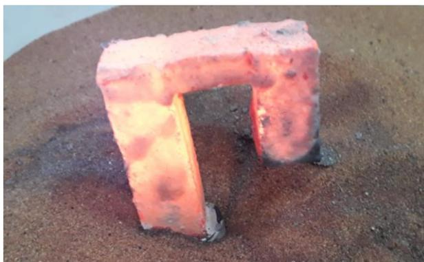
Рисунок 6 – Отливка во время выбивки из формы
