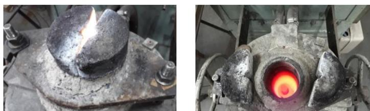
Рисунок 1 – Плавильная печь Таммана в процессе выплавки чугуна
