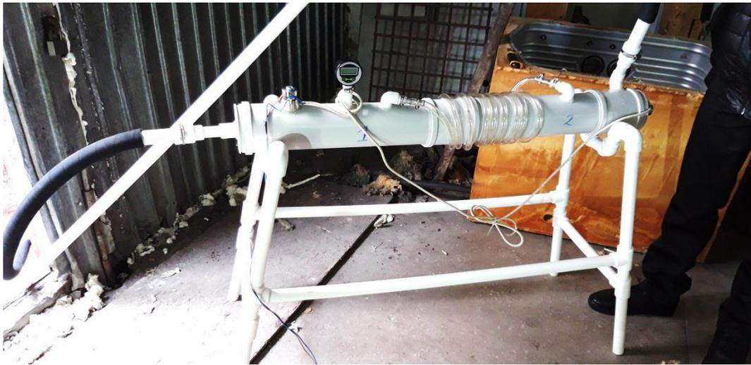
Рисунок 3.12- Подключение двухсекционного экспериментального ультразвукового автомобильного глушителя №1
