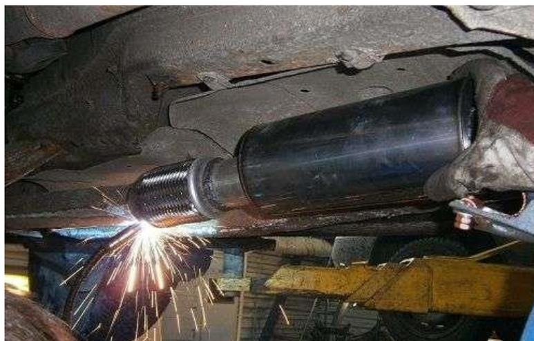
Рисунок 4.1 – Ремонтные работы автомобильного глушителя
