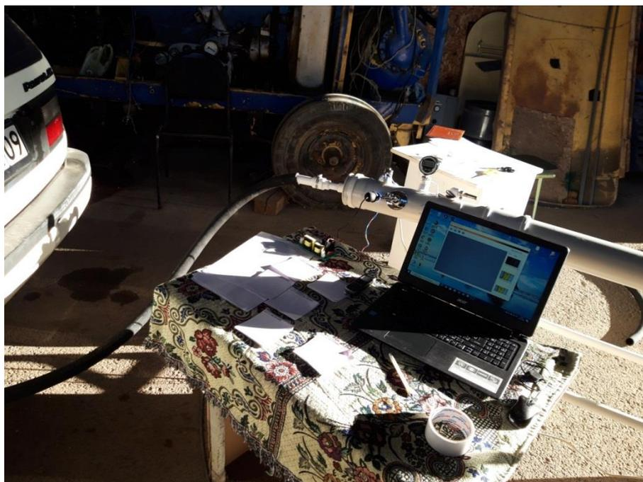
Рисунок 3.16 - Запуск экспериментального ультразвукового автомобильного глушителя №2
