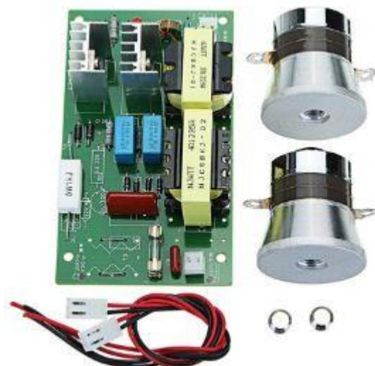
Рисунок 3.10 - Ультразвуковой генератор с излучателями ультразвуковых волн
