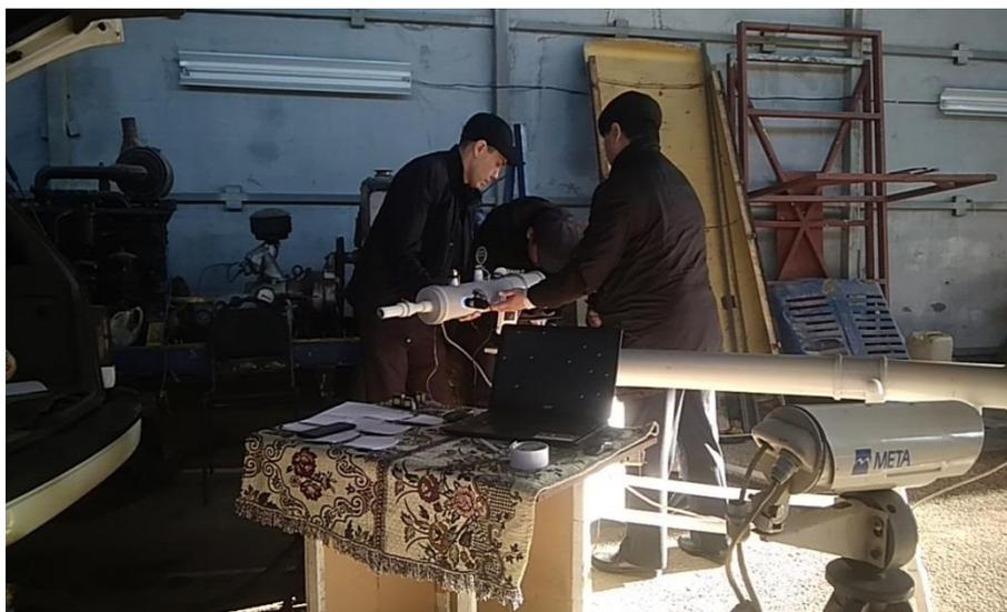
Рисунок 3.20 - Извлечение пронумерованных листов из экспериментального ультразвукового автомобильного глушителя №2
