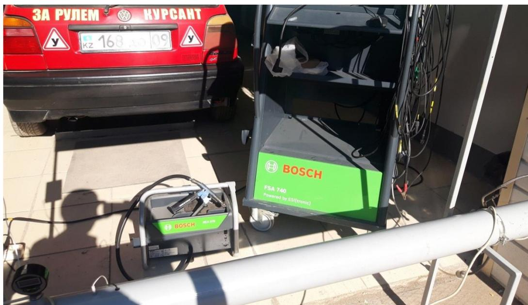
Рисунок 3.9 - Газоанализатор «Bosch FSA 740»
