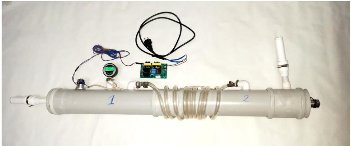
Рисунок 3.1- Двухсекционный экспериментальный ультразвуковой автомобильный глушитель №1
