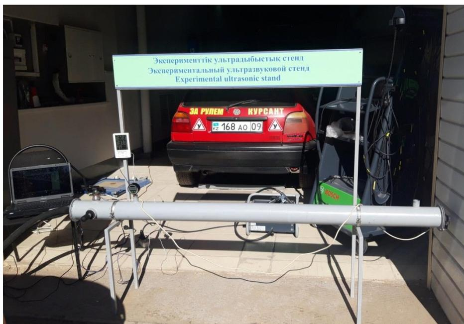
Рисунок 3.6 – Экспериментальный металлический ультразвуковой автомобильный глушитель №3
