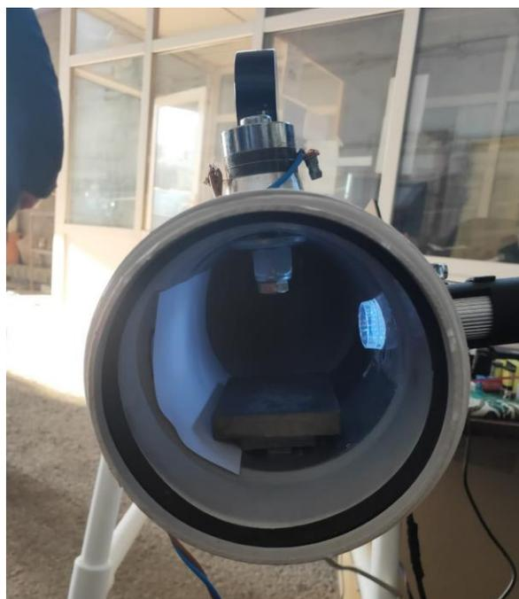
Рисунок 3.4 - Внутренняя конструкция экспериментального полипропиленового ультразвукового автомобильного глушителя №2
