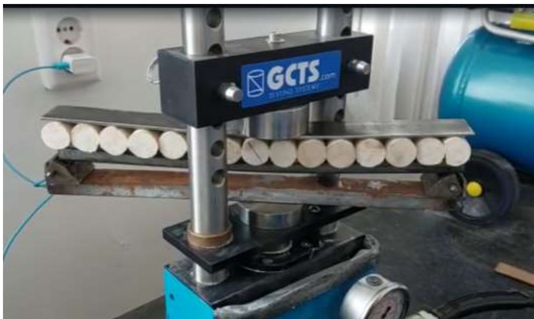
Сурет 4.2 – Күшейткіштері жоқ балканы сынау
