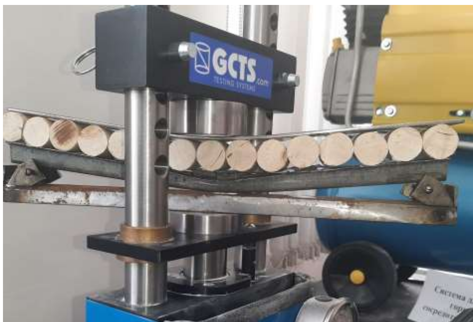
Сурет 4.3 – 3 күшейткіштері бар балканы сынау
