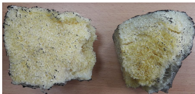
Сурет 6.12 – «БлокпурС» шайырының көбіктенген қатып қалған массасы
