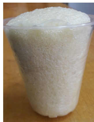
Сурет 6.11 – «БлокпурС» шайыр және бастапқы компоненттері
