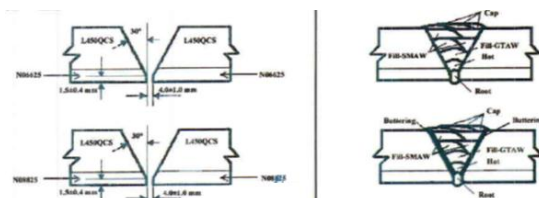
Рисунок 1 – Результат, технологическая карта сварки двухслойных материалов (CRA)
