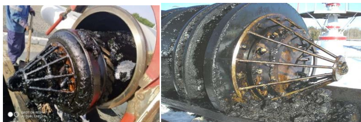
Сурет 4 – Қырғышпен әкелінген парафинді шөгінділер
