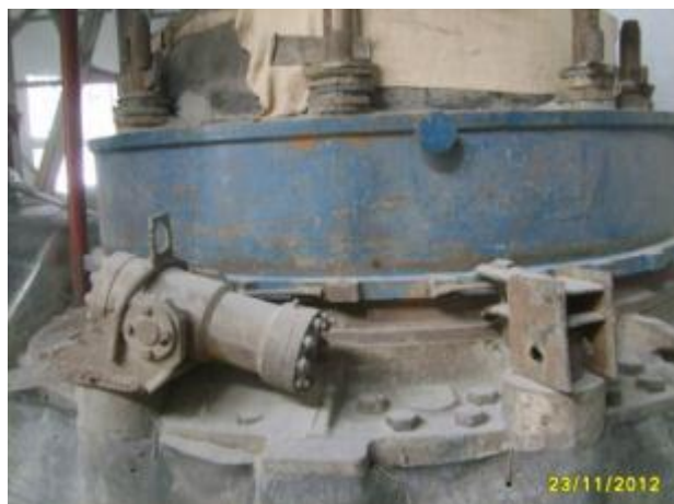
Рис. 4 Гидравлическая система регулирования разгрузочной щели
