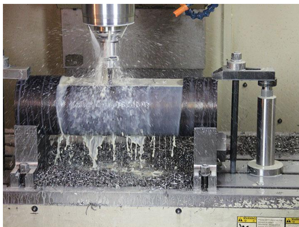
Сурет 5 – Гидравликалық балғаның поршенін өңдеу операциясы.
