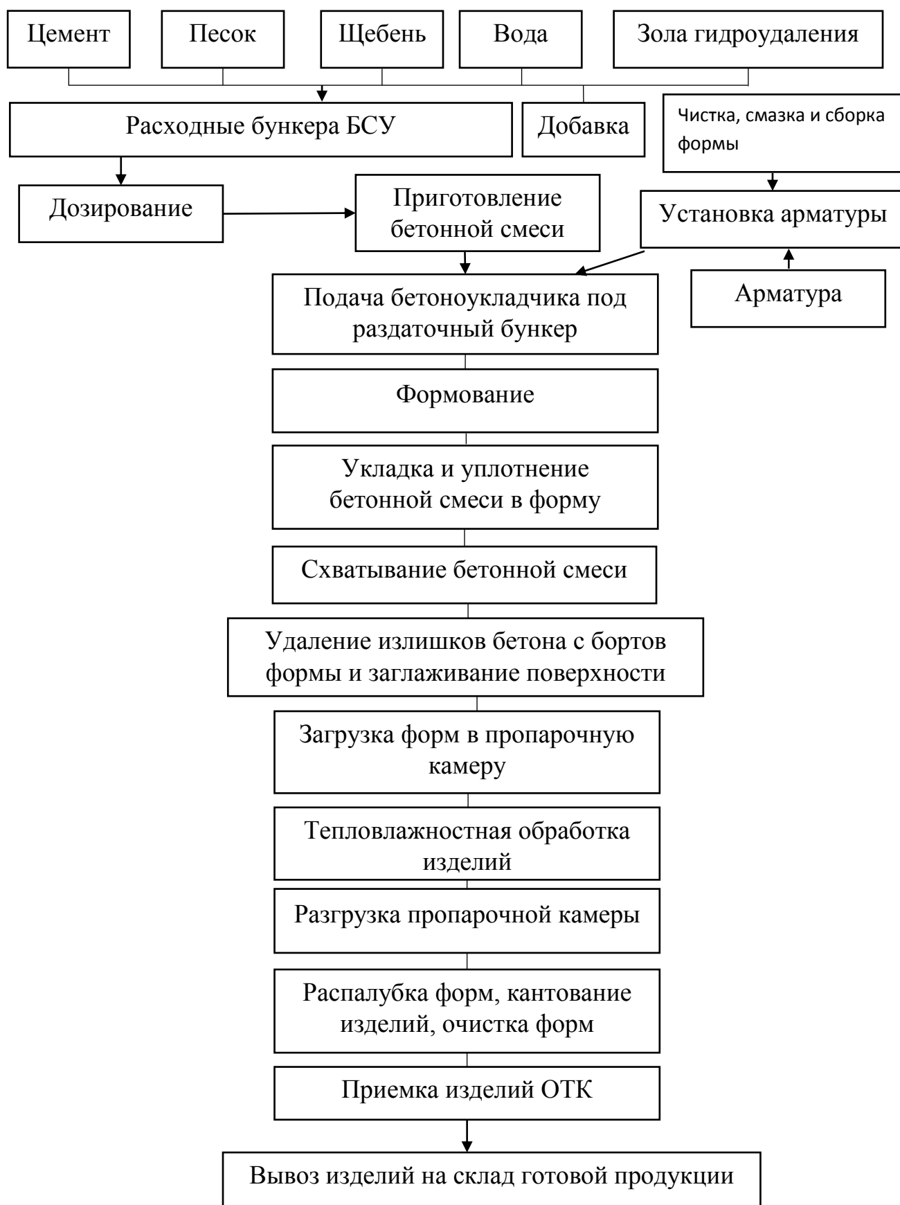
Рисунок 1 - Функционально-технологическая схема изготовления дорожных плит
