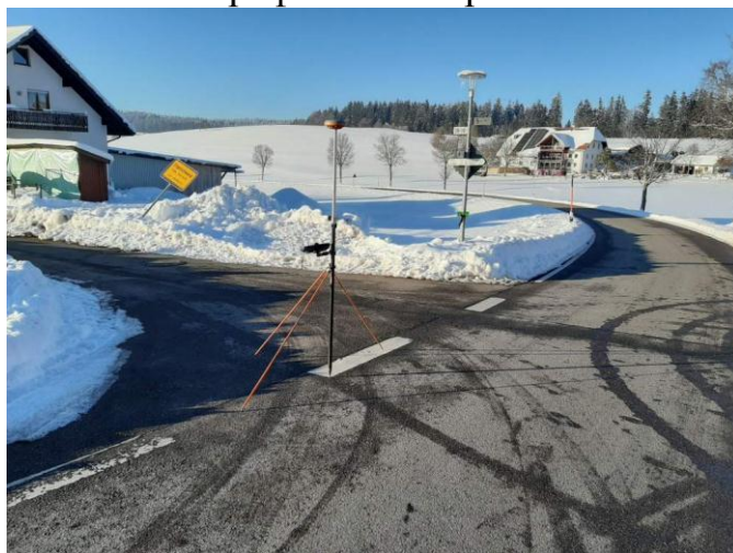
Рисунок 2 – Определение координат опознаков для аэрофотограмметрической съемки
