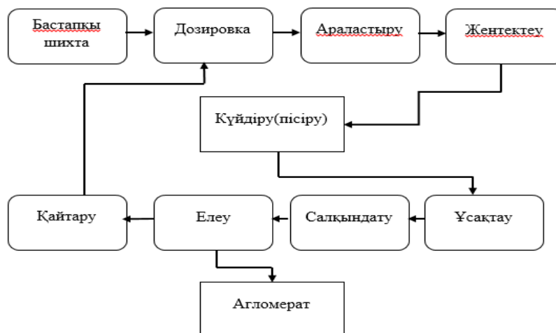
Сурет 1 – Агломерат алудың технологиялық схемасы
