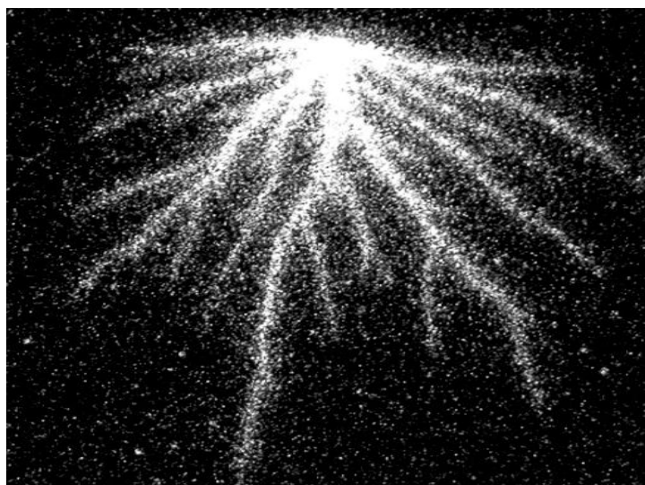
Рисунок 4 – Фотография коронного разряда с положительного электрода
