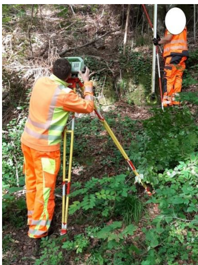
Рисунок 5 – Высокоточные нивелирные измерения
