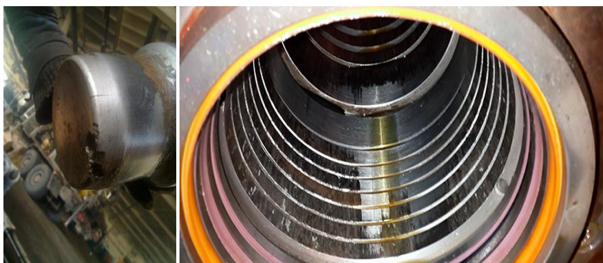
Сурет 4 – Гидравликалық балға, жұмыс құралы және соққы блогының корпус болаты шаршау себеінен бұзылғандар
