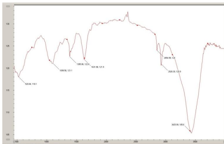
Сурет 3. Жаңаарқа мұнай интенсификаторы қатысында бутилді натрий ксантогенаты жинағышымен флотациялық байыту жағдайындағы Нұрқазған мыс-сульфидті кен үлгісінің ИҚ-спектрлік сараптама кескіні
