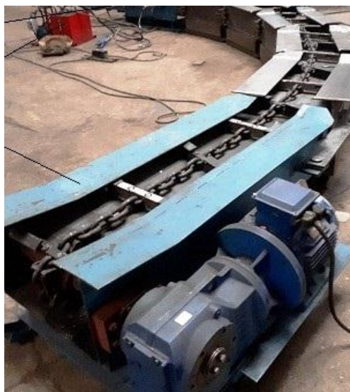
1-сурет. Айналмалы конвейер үшін жазық шарнирлерді пайдалану Конвейер күрделі қозғалысты штректен камераға 90 градуска бұрумен жүзеге асырады.
