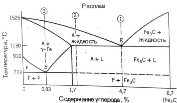
3. Пользуясь фазовой диаграммой, изображенной на рисунке, объясните, почему сплав Fe-C, содержащий 1% углерода, может быть твердым и хрупким или гибким и ковким в зависимости от того, с какой скоростью его охлаждают от исходной температуры 1400 °C.
