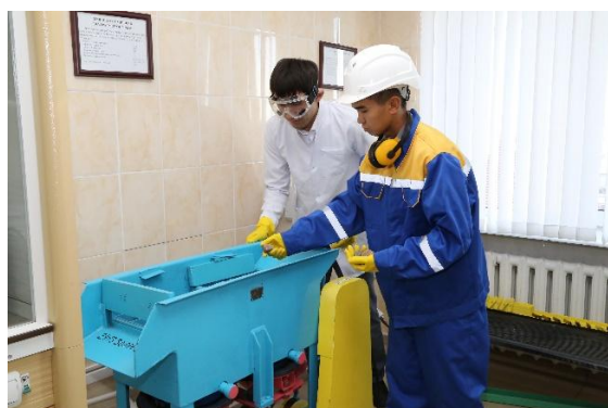
Обучающиеся ОП «Обогащение полезных ископаемых» проводят исследование на концентрационном столе, где происходит обогащение минералов руды, получают концентрат и породу (2020 г.). На фото: Амангельдинов А.А., Төкіш Қ.
