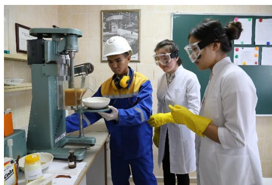
Обучающиеся ОП «Обогащение полезных ископаемых» проводят пенную флотацию на флотационной машине и получают медный концентрат (2020 г.). На фото: Амангельдинов А.А., Шәкенова А., Бектасова Н.
