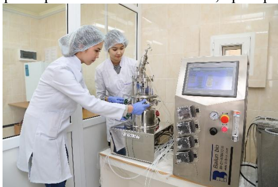
Микроорганизмдерді өсіруге арналған биореакторға қоректік ортаны қосу процесі (2020ж).
