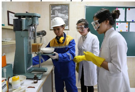
«Пайдалы қазбаларды өңдеу» ББ студенттері флотациялық машинада көбік флотациясын жүргізеді және мыс концентратын алады (2020 ж.). Суретте: Амангелдинов А.А., Шәкенова А., Бектасова Н.
