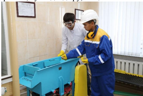
«Пайдалы қазбаларды өңдеу» ББ студенттері кенді минералдар байытылған, концентрат және тау жыныстары алынатын концентрация кестесінде зерттеулер жүргізеді (2020 ж.). Суретте: Амангелдинов А.А., Төкіш Қ.
