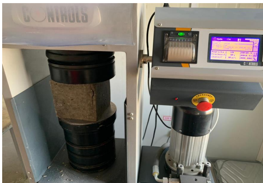
5.6 сурет - «Controls» гидравликалық прессі
