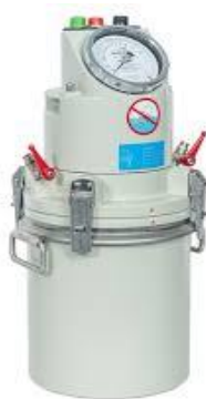
5.3 сурет – Тұтылған ауаның көлемін анықтайтын Германияның «TESTING» аспабы
