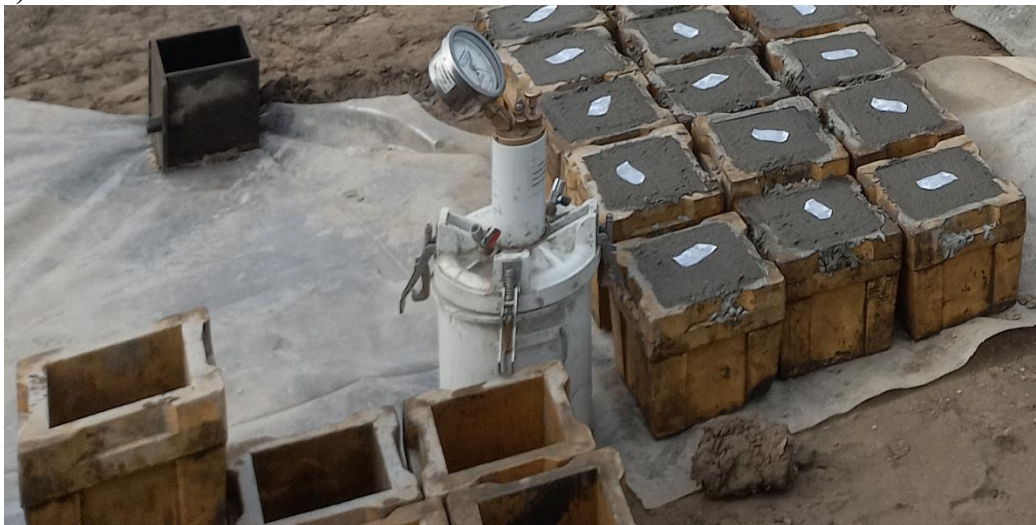
5.4 сурет – В35 класты ауыр бетонның тәжірибелік партиясынан алынған үлгілер
