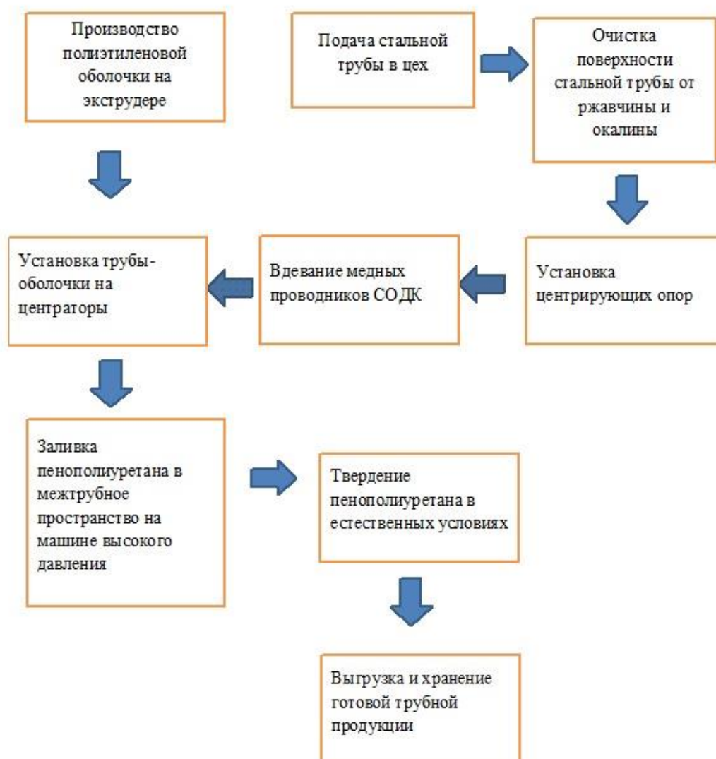
Рисунок 7 – Принципиальная блок-схема технологии трубной изоляции из пенополиуретана с полиэтиленовой оболочкой
