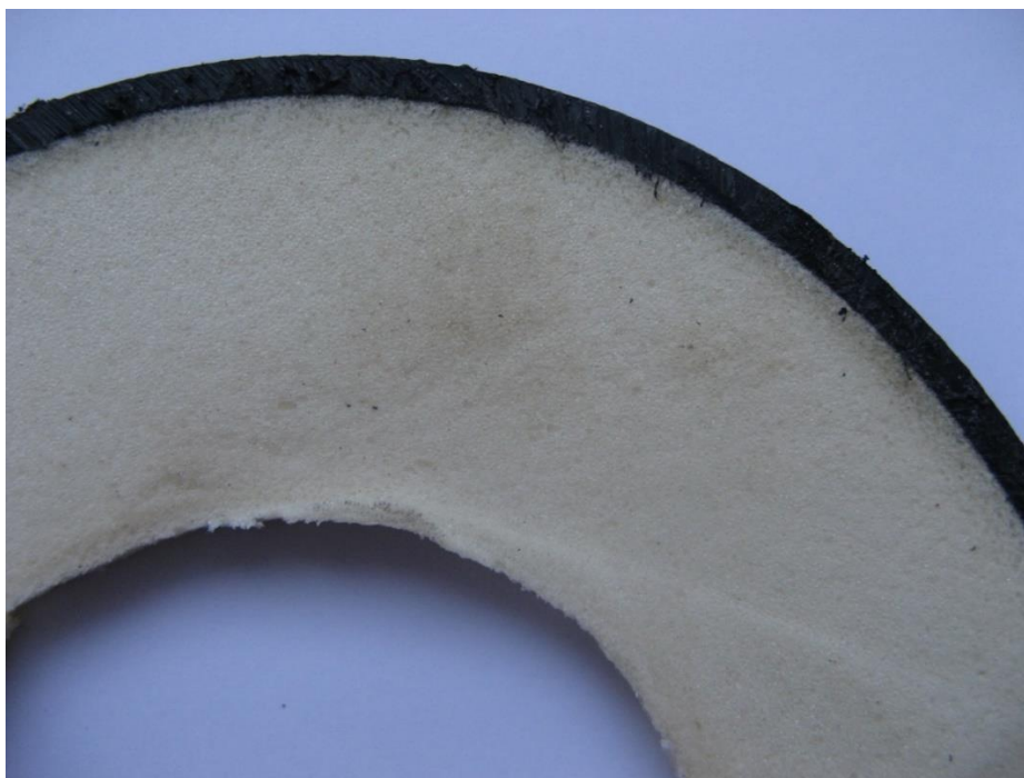
Рисунок 23 – Фрагмент среза трубы в пенополиуретановой изоляции в полиэтиленовой оболочке при увеличении в 10 раз
