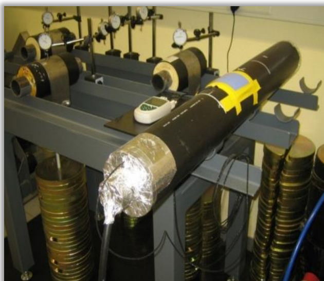
Рисунок 29 – Экспериментальная установка для измерения теплопроводности
