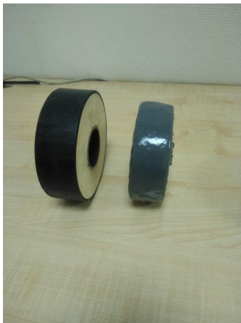
Рисунок 20 - Образцы трубы. Слева - в наружном корпусе из полиэтилена, справа - с покрытием из полимочевины
