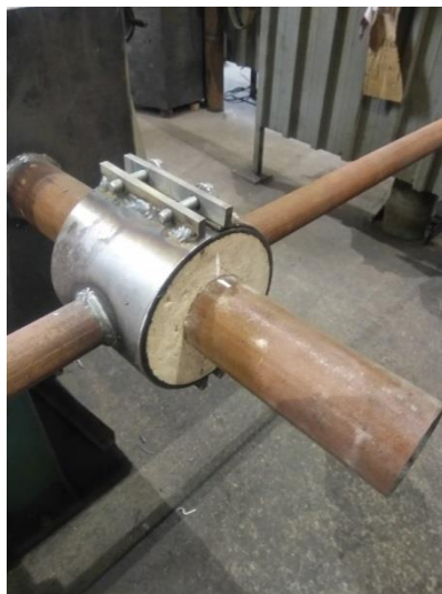
Рисунок 19 - Установка для определения прочности на сдвиг в тангенциальном направлении
