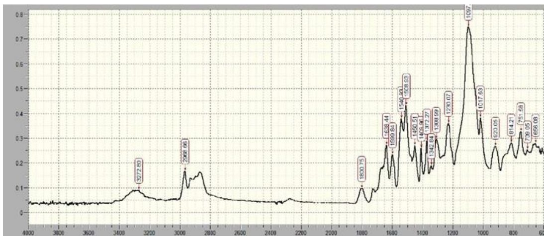
Рисунок 16 – ИК спектр полимочевины модифицированной стеклянными микросферами
