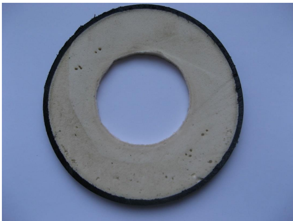
Рисунок 22 – Срез трубы в пенополиуретановой изоляции в полиэтиленовой оболочке
