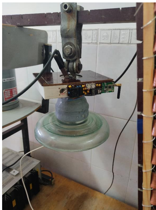
Рисунок 4.2 – Внешний вид лабораторного стенда для определения характеристик тока утечки изоляторов
