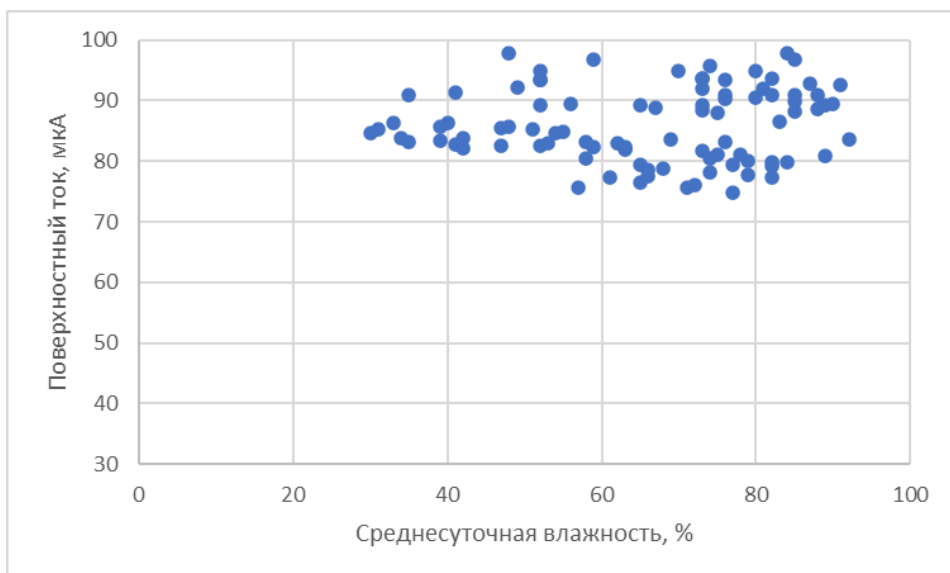
Рисунок 4.9 – Диаграмма рассеяния поверхностного тока от влажности
