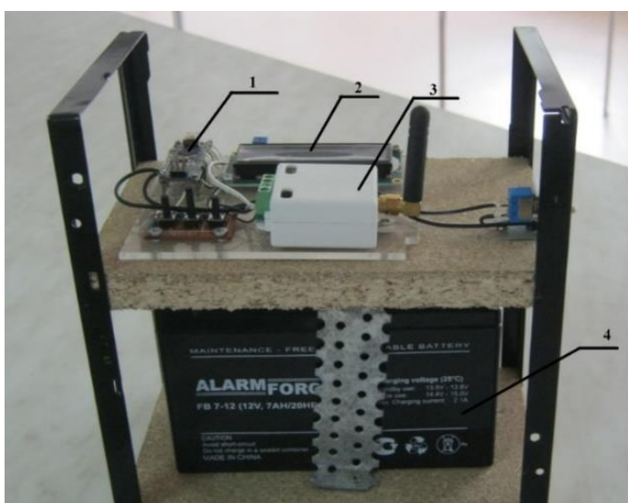
Рисунок 3.18 - Блок тестирования комбинированного датчика тока утечки
