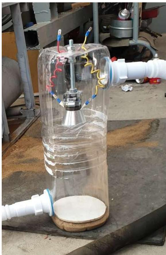
Рисунок 3.1 – Экспериментальная установка ультразвуковой очистки и утилизации отработавших газов ДВС
