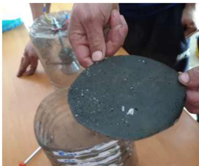
Рисунок 3.6 – Отражатель ультразвуковых волн после работы экспериментальной установки ультразвуковой очистки и утилизации отработавших газов
