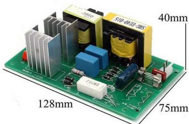
Рисунок 3.4 – Генератор ультразвуковых колебаний
