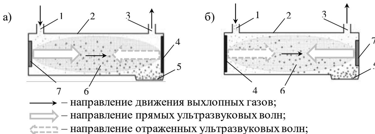
1 – впускной патрубок; 2 – корпус глушителя; 3 – выпускной патрубок; 4 – отражатель ультразвуковых волн; 5 – место сбора и извлечения сажевых частиц; 6 – зона стоячих волн; 7 – излучатель ультразвуковых волн
