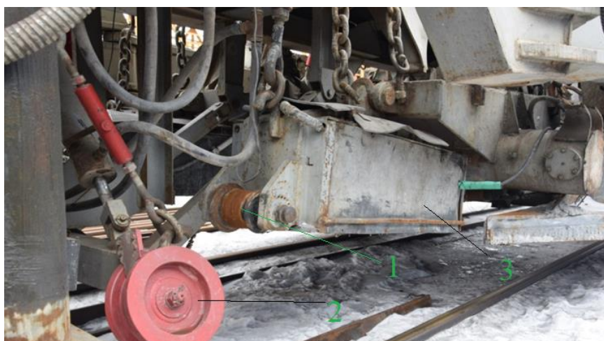
Сурет 4.5 – ВПО-3-3000 машинасының электромагнитті рельс қармауы 1 – электромагнитті катушқасы; 2 – тегістегіш ролик; 3 – электромагниттің корпусы
