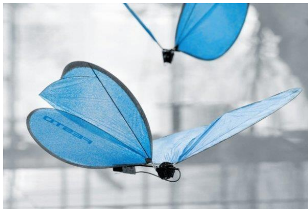
10 сурет. Бионикалық ұша алатын робот «Көбелектер»
