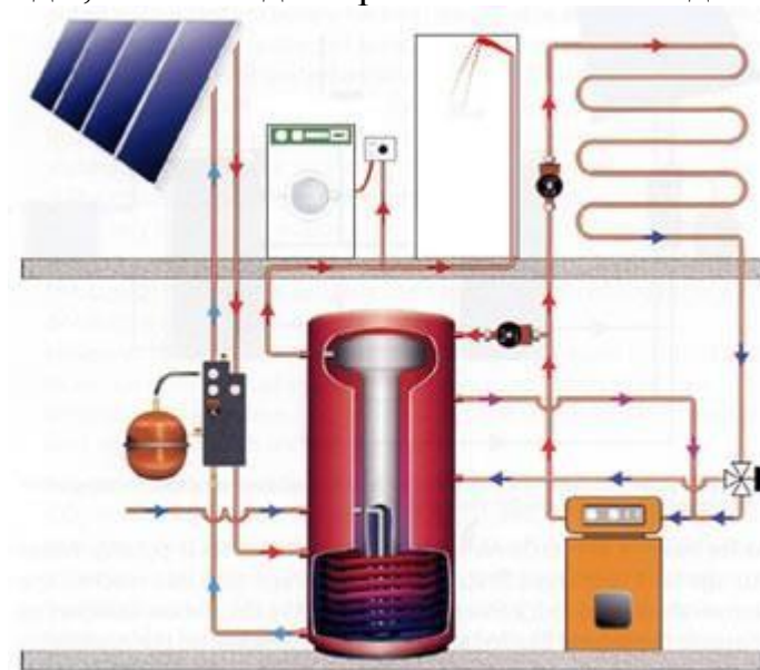
1.5 сурет. Активті күн жүйесі, ыстық су және жылу қамтамасыз ету жүйесінің схемасы
