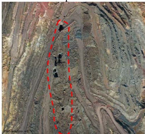
Рисунок 1 – Деформационный процесс, вызванный подземными горными работами
