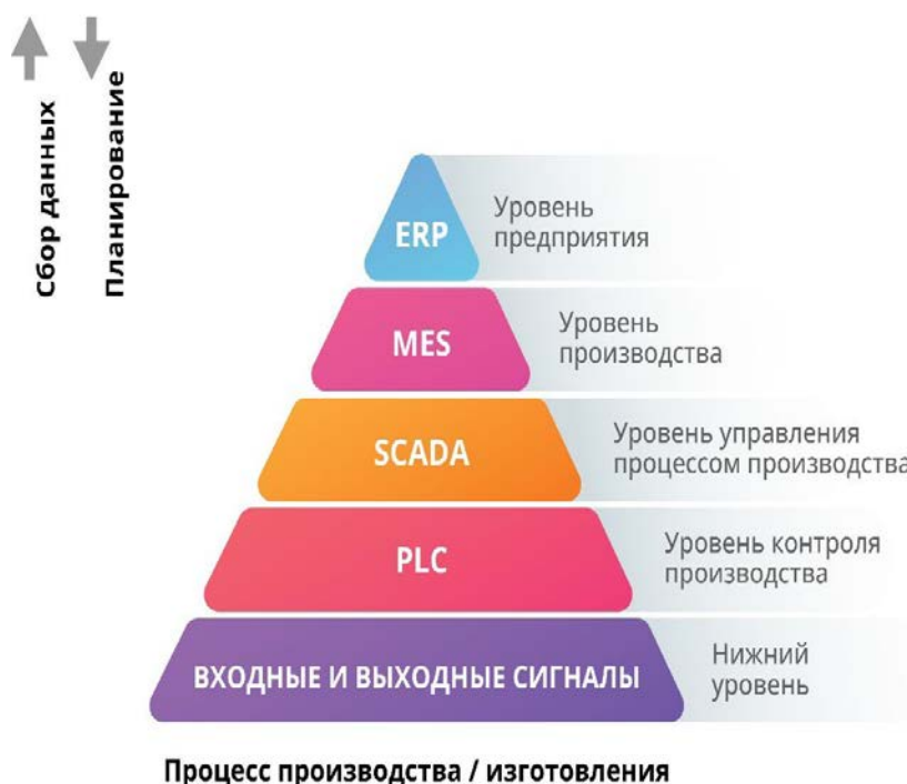
Рисунок 1 – Иерархическая структура ISA-95 (Пирамида автоматизации), иллюстрирующая интеграцию данных от ПЛК до MES и ERP.
