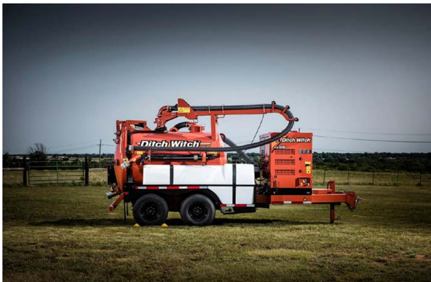
Рисунок 1- Вакуумная установка для извлечения забоечного материала (щебня).
