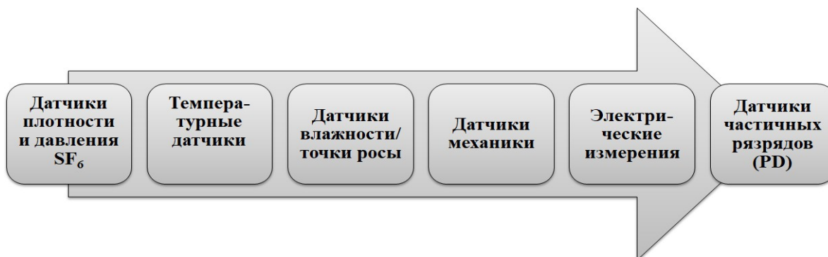
Рисунок 1. Схема датчиков и сенсоров установленных на выключателях
