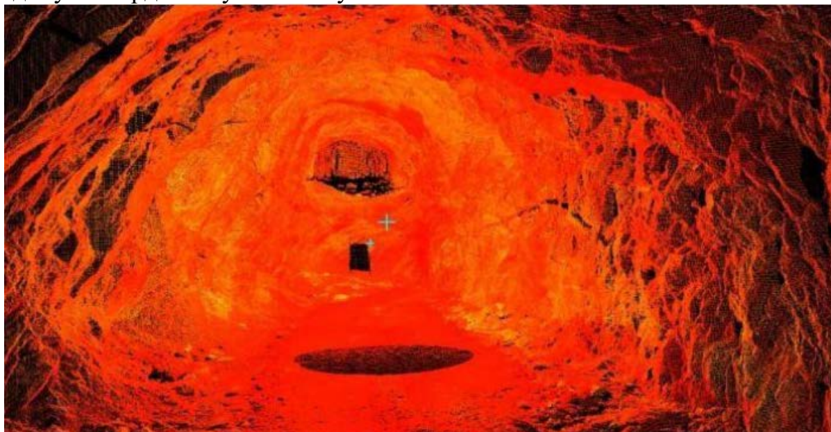
Рис.1 Облако точек, с одной станции лазерного сканера
