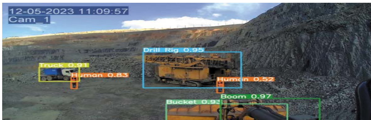
Сурет 1- Жүк тиегішпен қоршалған жүк көлігін және бұрғылау қондырғысын тану
