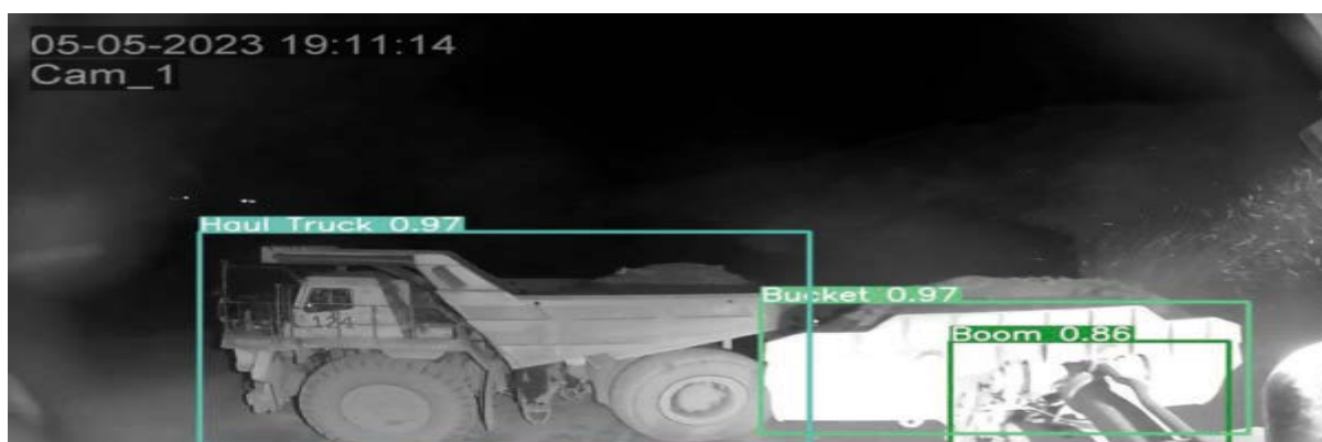
Сурет 2 - Тиегіш пен самосвалдың жұмыс бөлшектерінің жағдайын тану
