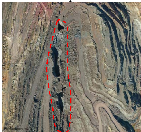
Рисунок 1 – Деформационный процесс, вызванный подземными горными работами
