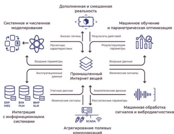
Рисунок 1 - Схема цифрового двойника производственного комплекса
