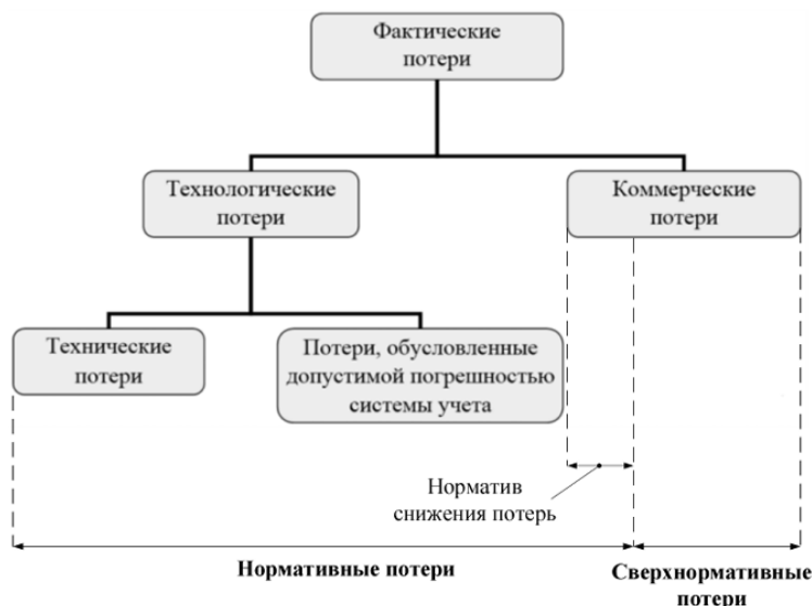
Рисунок 1 - Структурная схема системы снижения потерь электроэнергии в распределительных сетях
