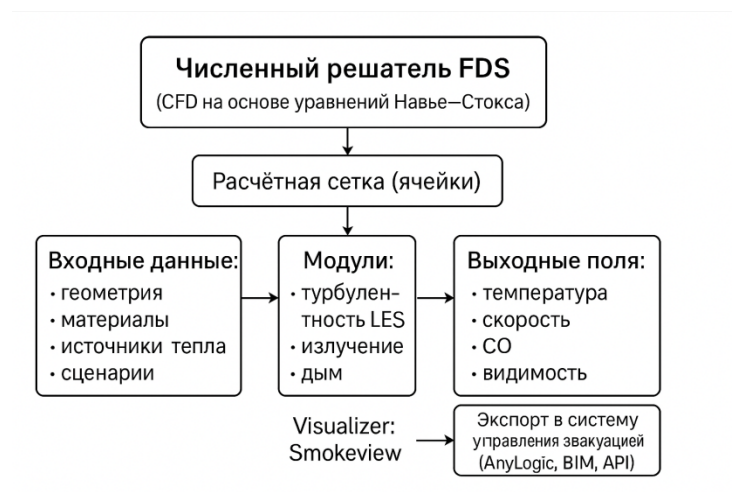
Рисунок 1 – Принцип работы Fire Dynamics Simulator
