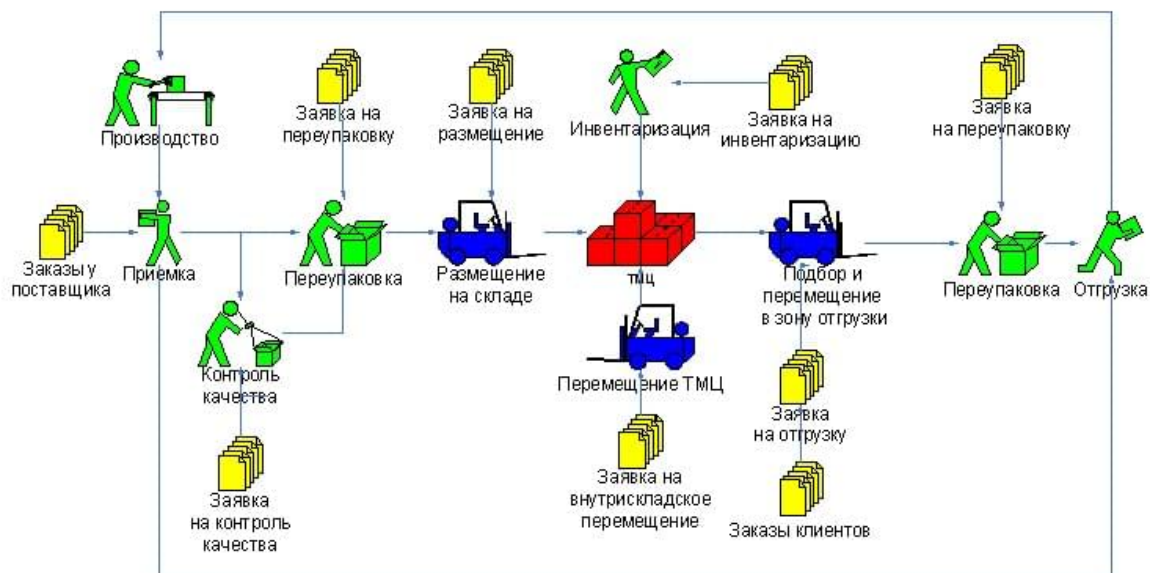
Рисунок 1 - Схема взаимодействия цифровых компонентов логистической системы
