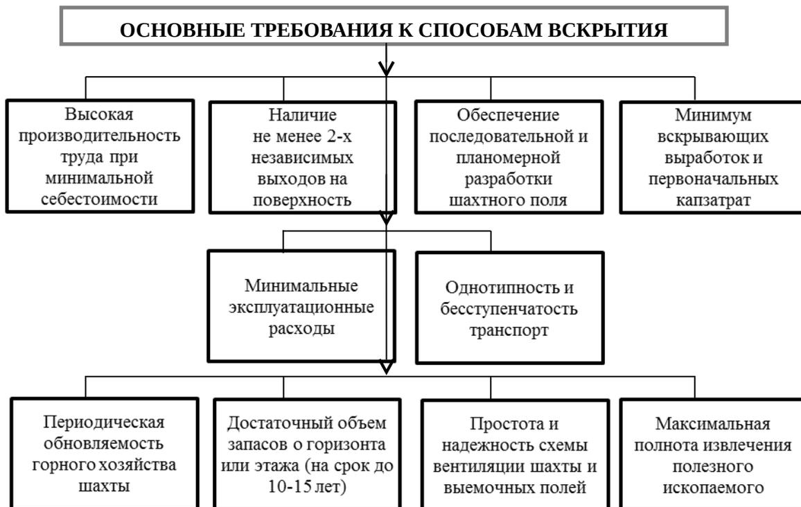
Рисунок 2.6 – Основные требования, предъявляемые к способам вскрытия месторождений
