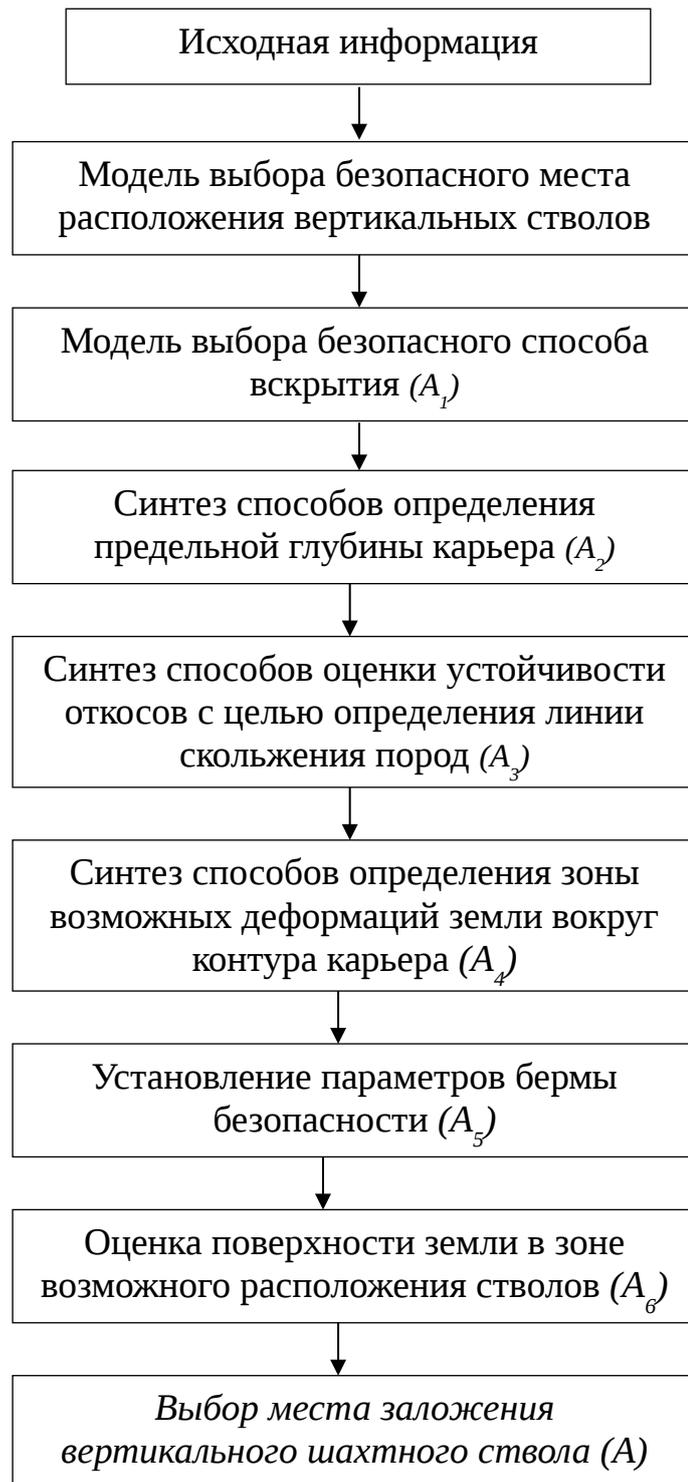
Рисунок 2.16 – Алгоритм последовательной локальной оптимизации процесса выбора места расположения вертикального ствола
