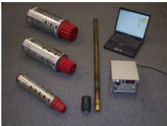
Сурет 4.12 – RMRS ұңғымаларын әртүрлі ұңғымалар өлшемдеріне бағыттауға арналған жабдық
