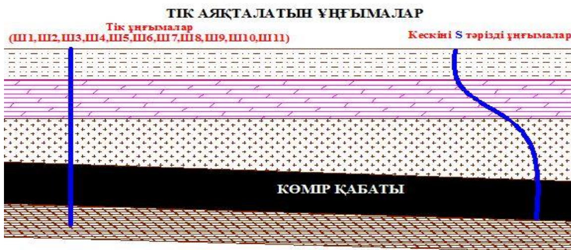
Сурет 3.4 – КҚМ өндіру үшін қолданылатын тік ұңғыма профилдерінің түрлері
