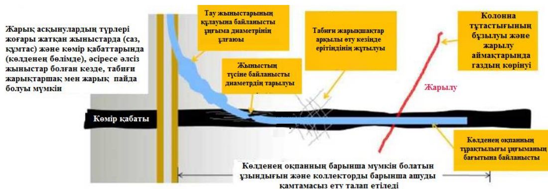
Сурет 4.9 – Көмір қабаттарында көлбеу-бағытталған бұрғылау кезіндегі қауіптер
