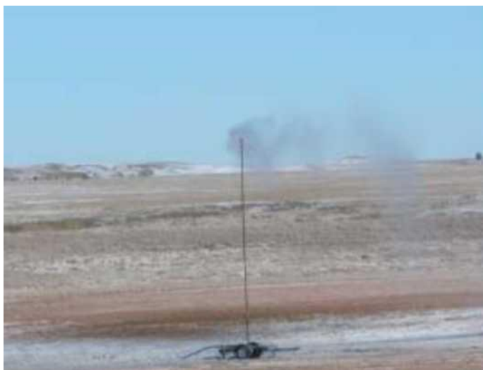
Сурет 1.26 – Powder River кен орнында ілеспе суды тозандату (аэрация)
