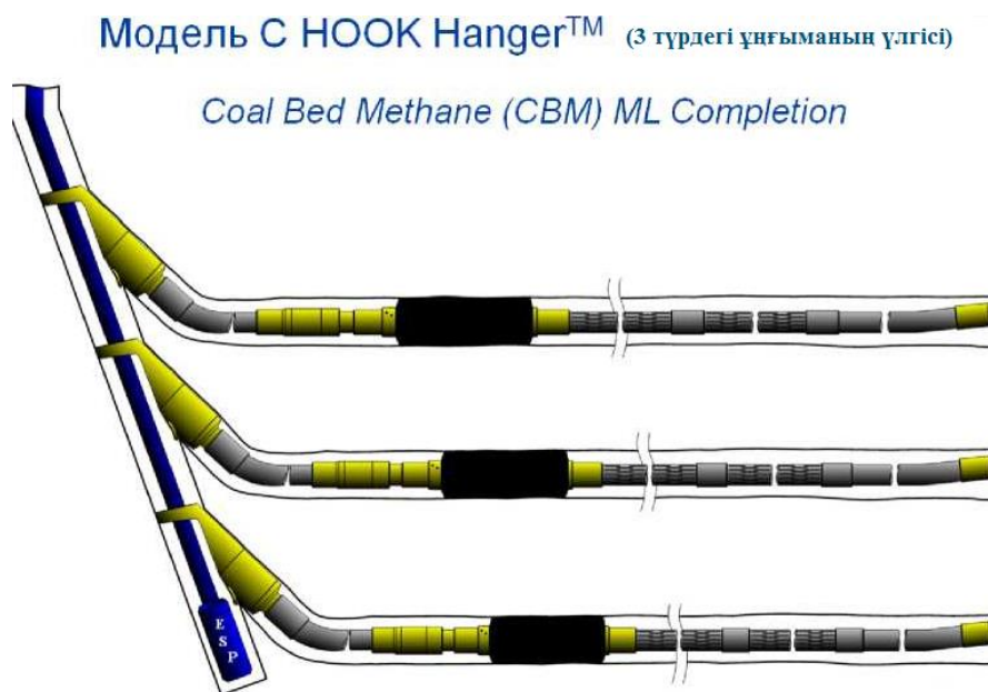
Сурет 4.11 – C HOOK Hanger үлгісі мысалы, 3 түрдегі ұңғыма - көлденең секцияларды сүзгі-қалдықпен аяқтау
