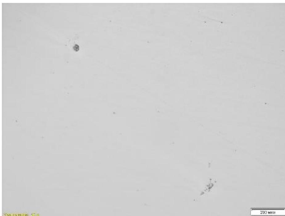
Рисунок 17 – Микроструктура образца X18904346 до травления  $\times 100$
