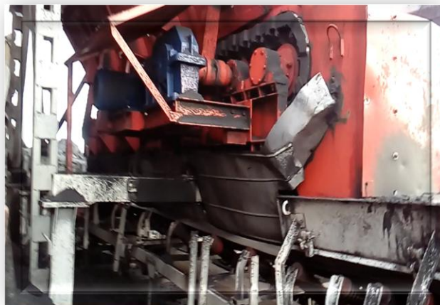
Сурет 1.6 - Көмір разрезі «Молодежныйда» қатпарлы конвейер: а - алдынан көрініс, б – шетінен қараған көрініс
