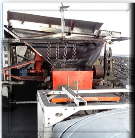
Сурет 1.6 - Көмір разрезі «Молодежныйда» қатпарлы конвейер: а - алдынан көрініс, б – шетінен қараған көрініс
