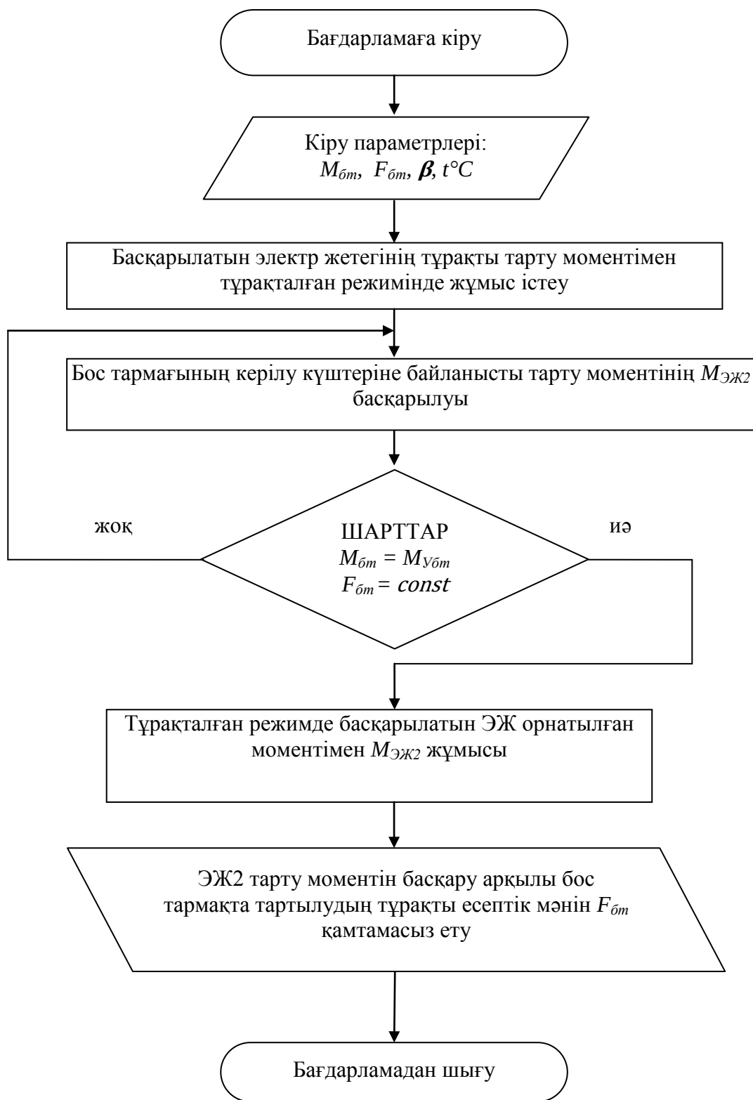
Сурет 4.6 - Қатпарлы конвейердің жиілік реттелетін электр жетектері арасындағы жүктемелерді басқару және тарату алгоритмінің Блок-схемасы (бос тармағының тұрақты тартылуын қамтамасыз ету)
