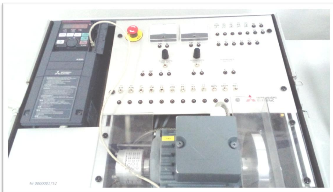
Сурет 5.4 - A800 жиілікті түрлендіргішпен бірге Mitsubishi Electric стенді
