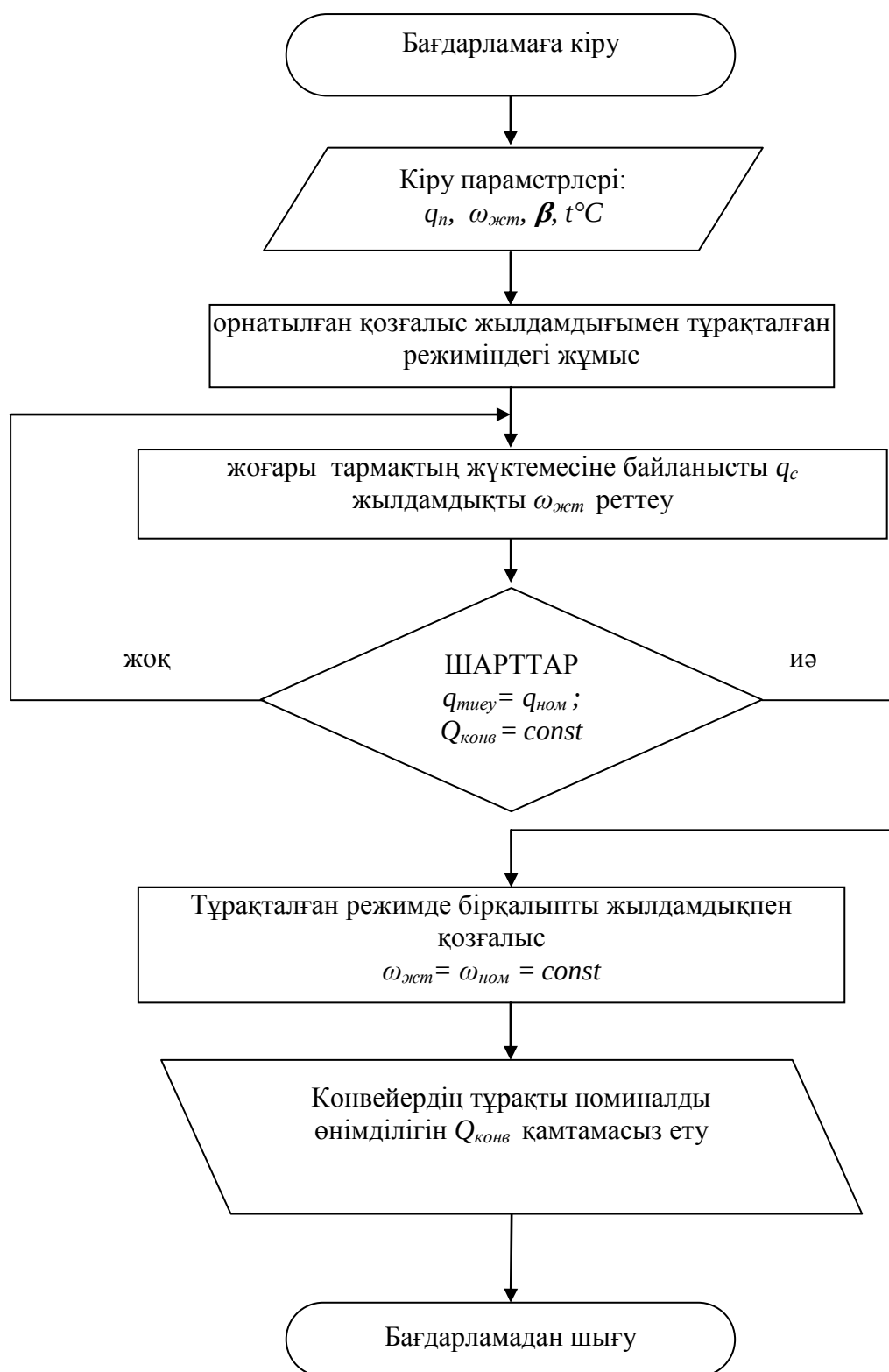
Сурет 4.5 - Қатпарлы конвейердің жиіліктік реттелетін электр жетектері арасындағы жүктемелерді басқару және тарату алгоритмінің блок-схемасы (тұрақты өнімділікті қамтамасыз ету)
