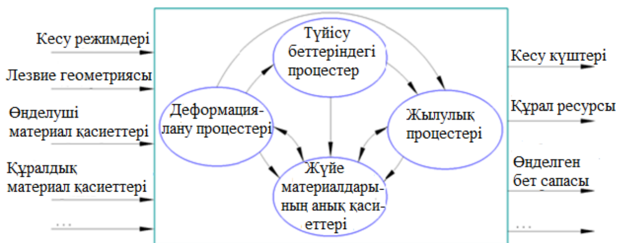
Сурет 4.1 – Жоңқа пайда болу аумағының физикалық модель үрдістері
