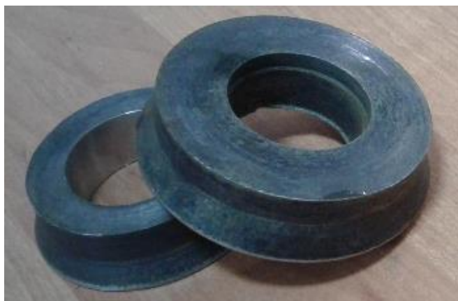
Сурет 5.1 – 65Г маркалы болаттан жасалған табақшалы кескіш
