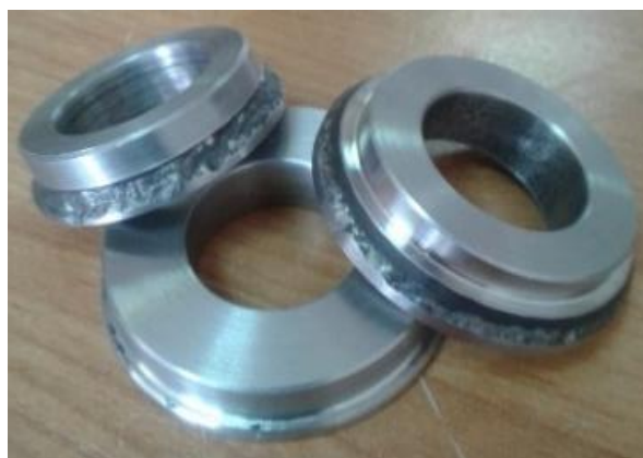
Сурет 5.2 – STOODY M7-G балқыма материалымен балқытып қапталған табақшалы кескіш
