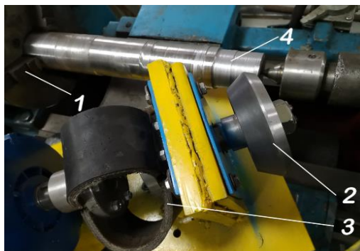
1 – білдектің үшжұдырықшалы патроны; 2 – балқыту материалдарымен қапталған арнайы үйкеліс фрезасы; 3 – әмбебап қондырғы; 4 – 30ХГСА болатынан жасалған дайындама
