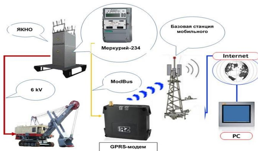
Рисунок 8 – Система удаленного мониторинга режимов работы экскаваторов
