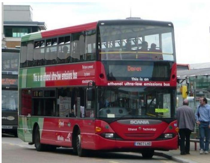
Рисунок 2 – Scania OmniCity - автобус с двигателем на этаноле
