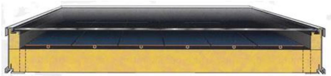
Рисунок 1 - Типичная конструкция плоского солнечного коллектора
