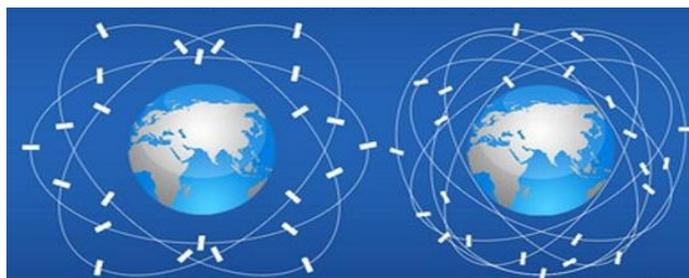
Рисунок 6 - Подсистема космических аппаратов ГЛОНАСС, 3 орбиты по 8 спутников (слева); подсистема космических аппаратов GPS, 6 орбит по 4 спутника (справа)
