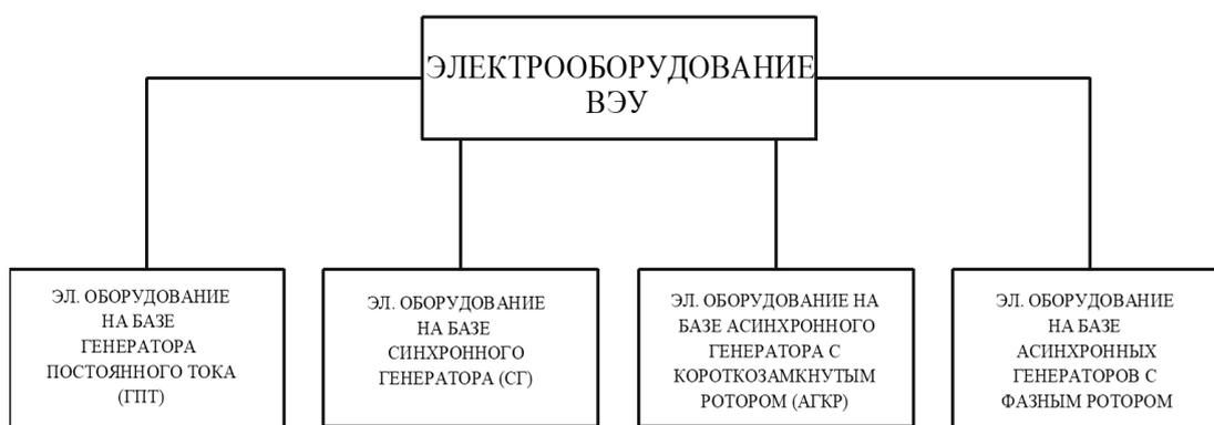
Рисунок 2 –Классификация по типам применяемых электрических машин
