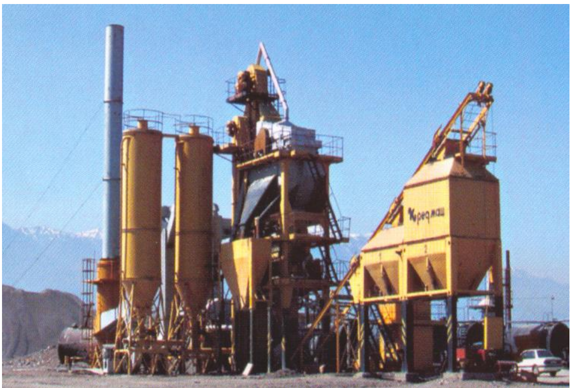
Установка по выпуску асфальтобетонной смеси
