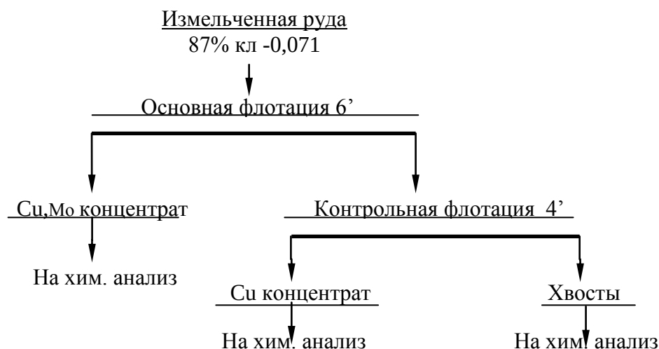
Рисунок 2.5 – Схема флотации для получения черного флотационного концентрата
