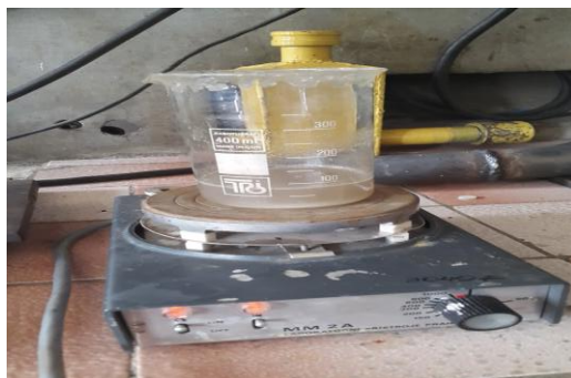
Рисунок 2.14 – Лабораторная установка по выщелачиванию огарка
