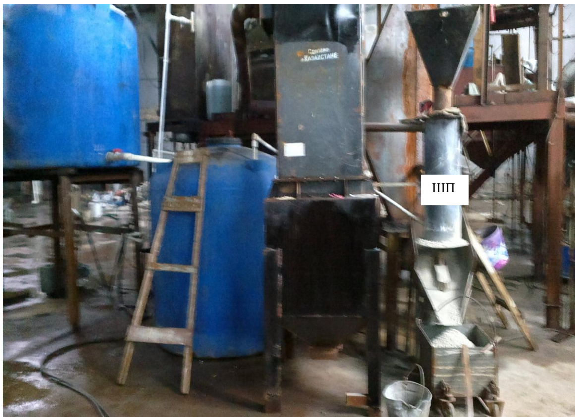
Рисунок 2.13 – Печь обжига шахтного типа с тарельчатым питателем.
