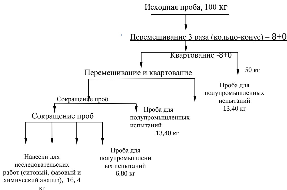
Рисунок 2.2 – Схема подготовки пробы к технологическим испытаниям
