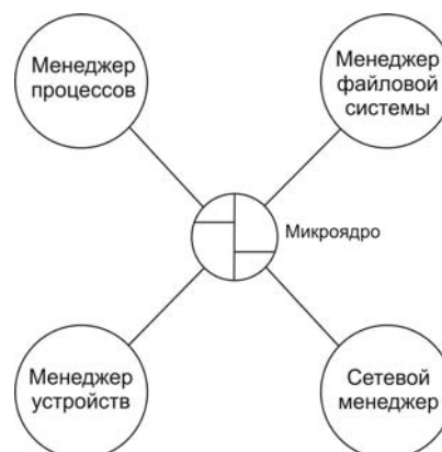
5. сурет. Жүйелік менеджерлермен суреттелетін QNX микроядросы
