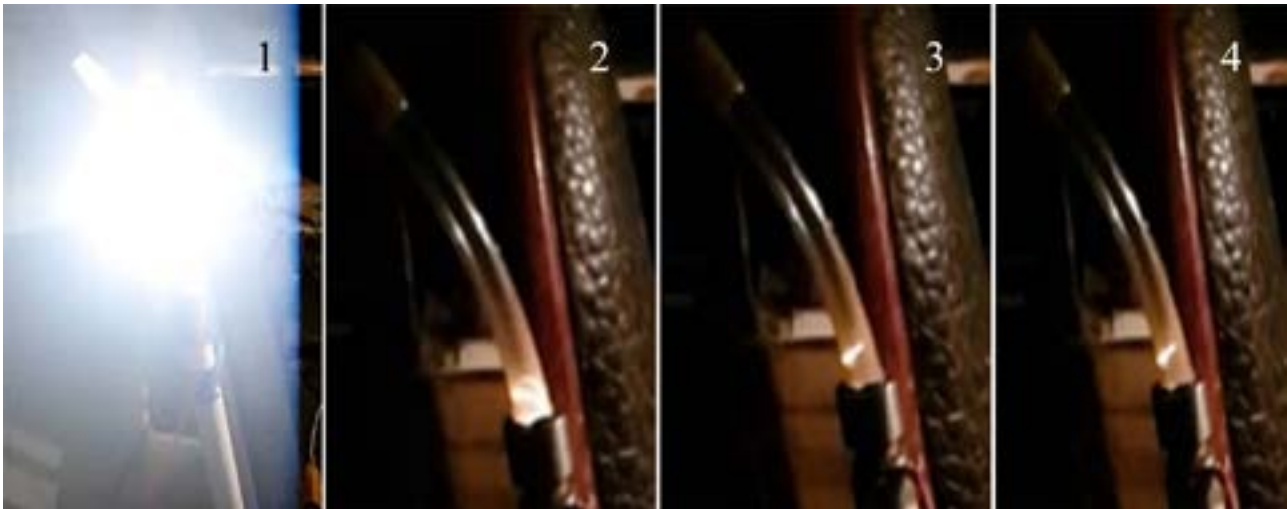
1 – завершённый разряд; 2 – появление газового шара в реакторе; 3, 4 – уменьшение размеров газового шара Рисунок 4 – Развитие частичного разряда в реакторе P1 U=950 В, R_6=0 , \Delta t = 1/240 с
