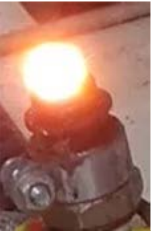
Рисунок 2 – Фотография газового шара при импульсном частичном разряде от схемы выпрямления переменного тока промышленной частоты с удвоением напряжения: U = 610 В, R_6 = 50 Ом, \Delta t = 1/30 с.
