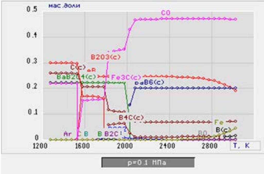
Рисунок 3 – Результаты моделирования производства сплава 11 с использованием оксидов бария и бора в диапазоне температур 1273-3000 К
