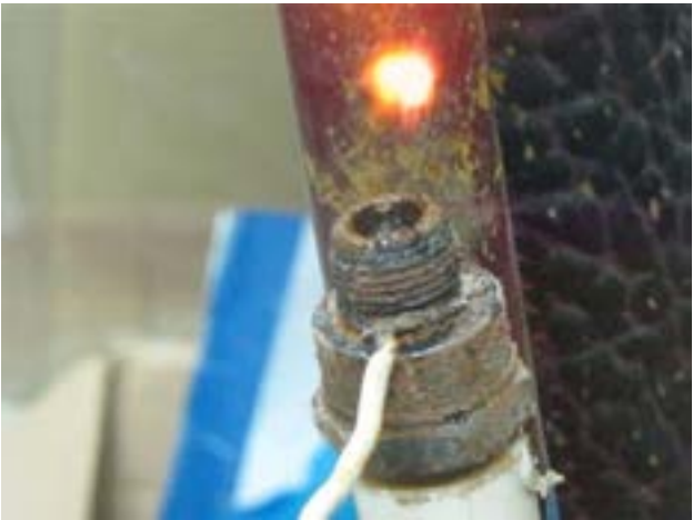
Рисунок 1 – Фотография газового шара при импульсном частичном разряде от RC-генератора: U = 950 В, R_6 = 68 Ом, \Delta t = 1/30 с
