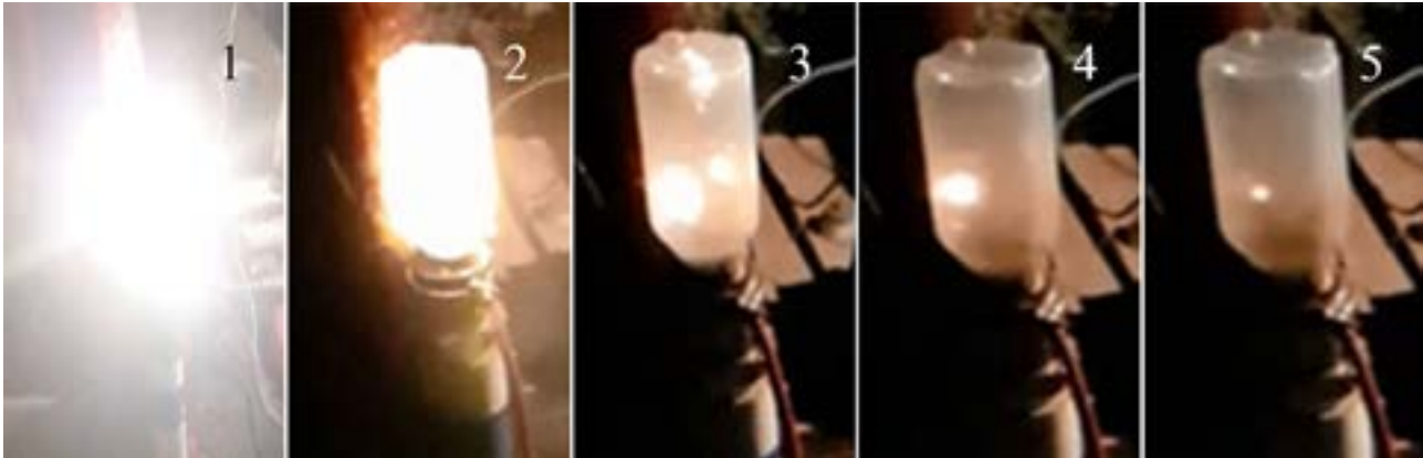
1 – завершённый разряд; 2 – излучение газа в реакторе; 3 – образование газового шара; 4,5 – охлаждение и затухание газового шара
