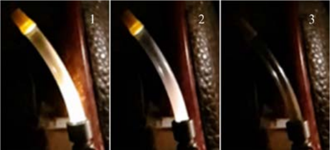
Рисунок 5 – Развитие частичного разряда в реакторе P1 U=950 В, R_6=68 Ом, \Delta t = 1/240 с
