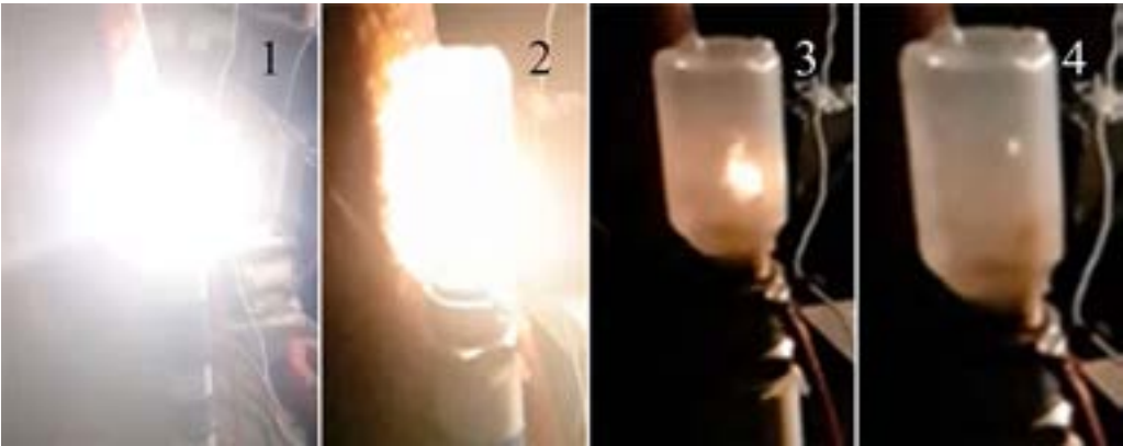
1 – завершённый разряд; 2 – излучение газа в реакторе; 3 – образование газового шара; 4 – потухание газового шара Рисунок 7 – Развитие частичного разряда в реакторе P2 U=950 В, R_6=68 Ом, \Delta t = 1/240 с
