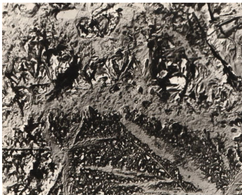
Рисунок 4.6 – Электронная микрофотография реплик с поверхности скола шлакового камня с добавкой 10% извести (х 14000)
