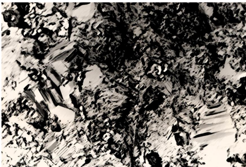
Рисунок 4.9 – Тоберморитовые кристаллы и портландитовые блоки, сросшиеся с гелеобразной фазой (шлаковый камень с 15% добавкой извести) x14000
