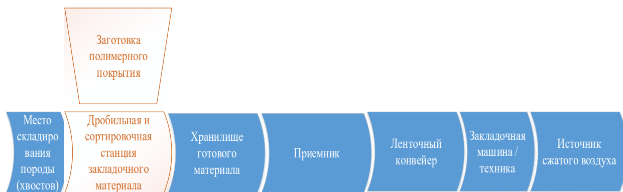
Рисунок 5.7 - Процесс нанесения полимерного покрытия во время закладочных работ
