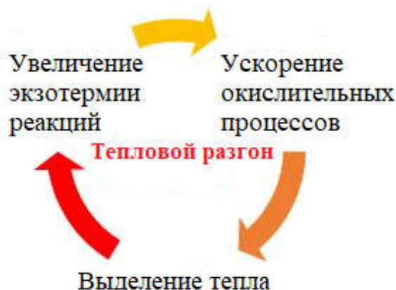
Рисунок 1.4 - Схема самонагревания и ускорения окислительных процессов
