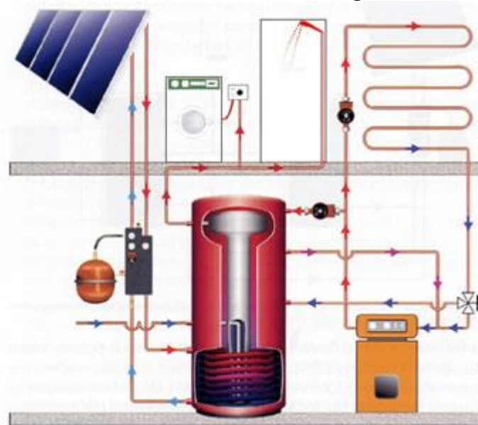
1.5-сурет – Активті күн жүйесі, ыстық су және жылу қамтамасыз ету жүйесінің схемасы
