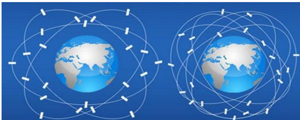
6-сурет – ГЛОНАСС ғарыш аппараттарының жүйесі, 8 серіктен құралған 3 орбита (сол жақта); GPS ғарыш аппараттарының жүйесі, 4 серіктен құралған 6 орбита (оң жақта)
