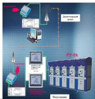
7-сурет – Жоғары вольтті подстанциялардың жұмыс режимдерін бақылау жүйесі
