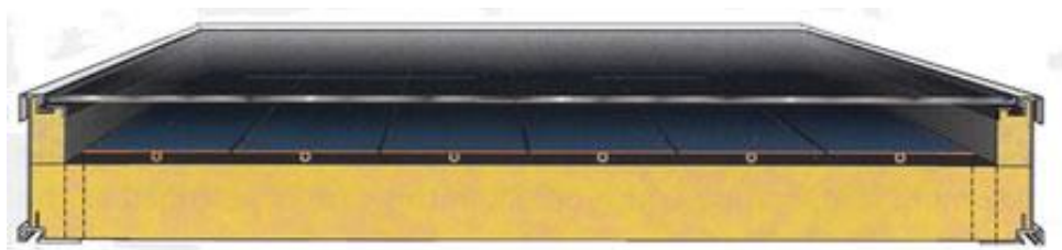
1.1-сурет – Жазық күн коллекторының типтік құрылымы
