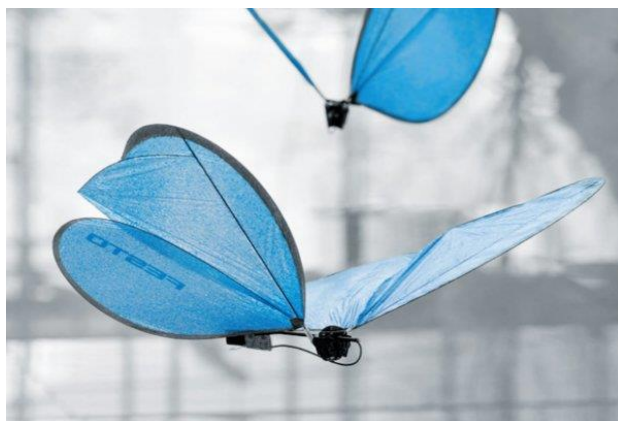
10-сурет– Бионикалық ұша алатын робот «Көбелектер»
