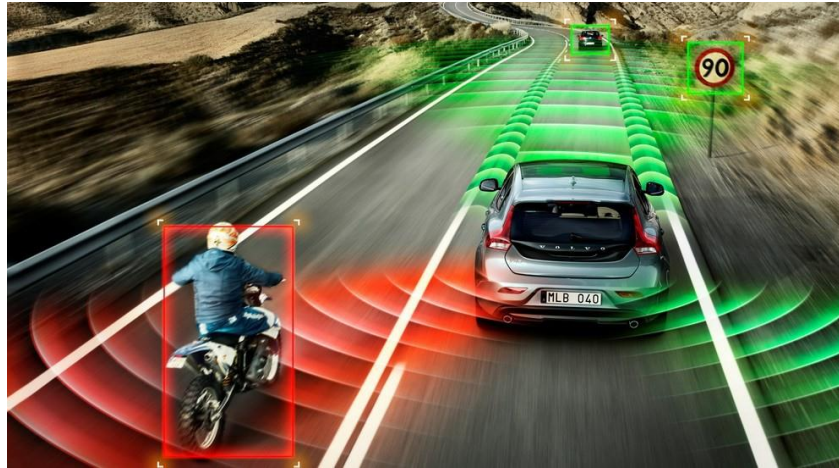
2-сурет – Өздігінен басқарылатын көліктің активті круиз бақылауышы
