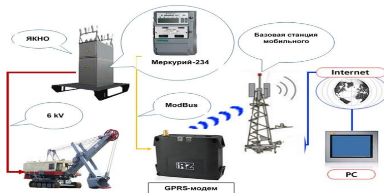
8-сурет – Экскаваторлардың жұмыс режимдерін алыстан мониторинг жүргізу жүйесі
