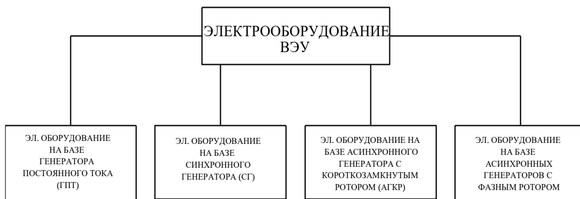
1.2-сурет – Электр машиналарының қолдану типіне байланысты жіктеуі
