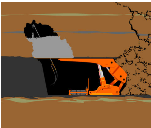
Рисунок 5.10 – Породные купола (а) в лаве и закачка (б) в них смолы
