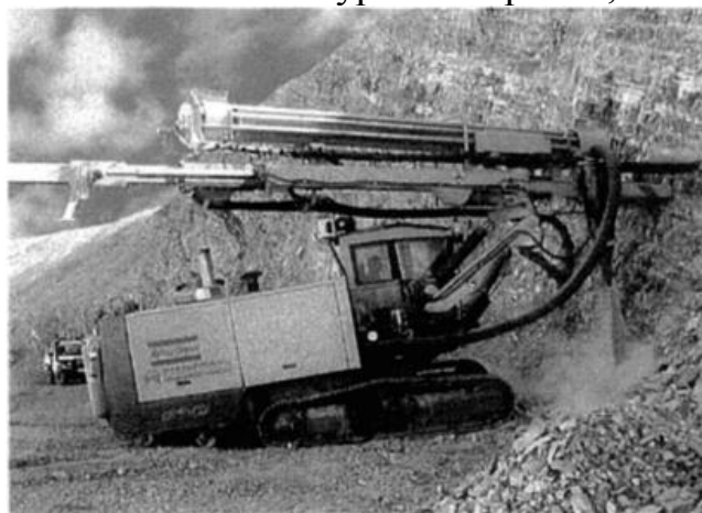
Рис.1. Горизонтальное бурение станком с пневмоударником Atlas Copco ROC L8
