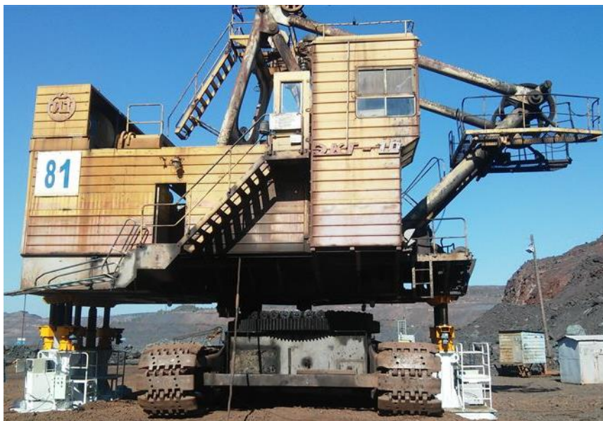
Сурет 1 – ЭКГ-10 экскаваторын КГПЭ4-125 гидравликалық кешенімен көтеріп және ұстап тұрған кезі
