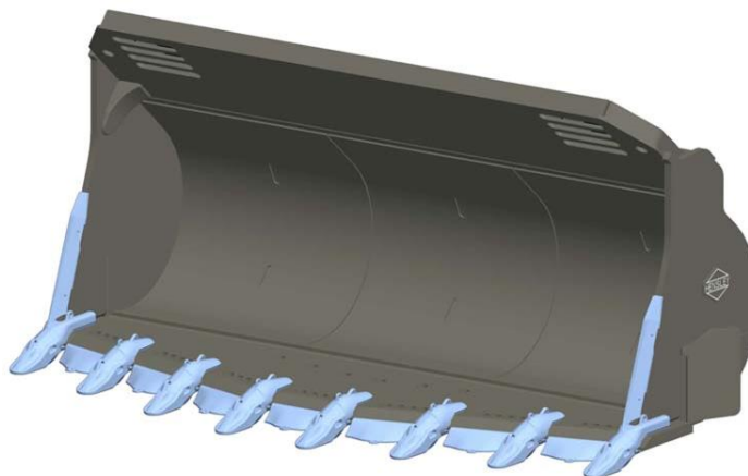
Рисунок 9 – Установка защитных накладок
