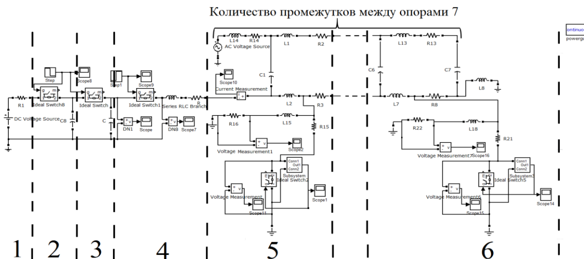
Рисунок 1 – Модель схемы замещения в ПП MatLab на участке ВЛЭП 500 кВ, длиной 2,5 км (8 опор)
