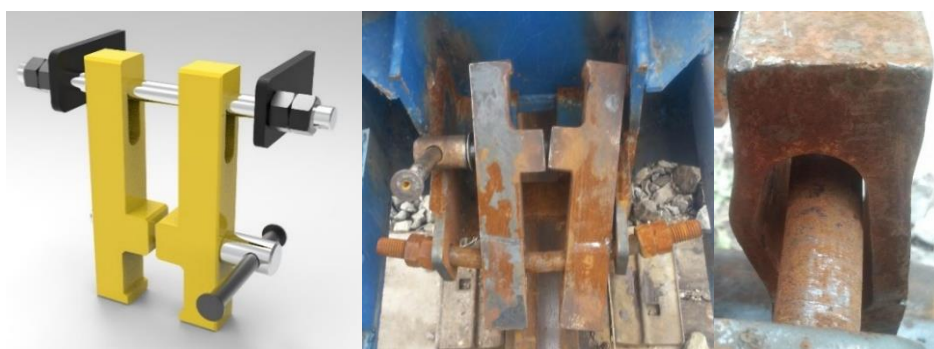
Рисунок 2 – Повреждения ручного противоугонного клещевого захвата крана ККС-10 с г/п 10 т.
