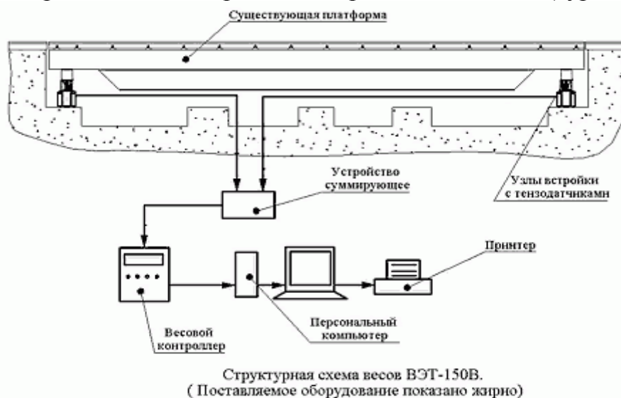
Сурет 1.1 - Тензодатчикті өлшеу құралының құрылымдық сызбасы
